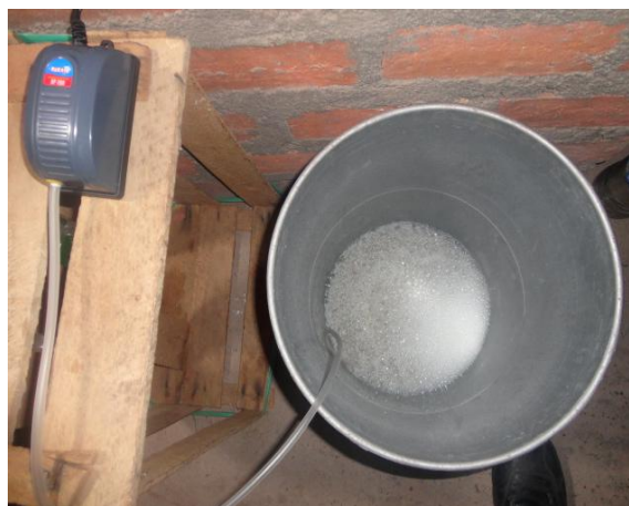
OXIDACIÓN DE SULFURO CON SULFATO DE MANGANESO
