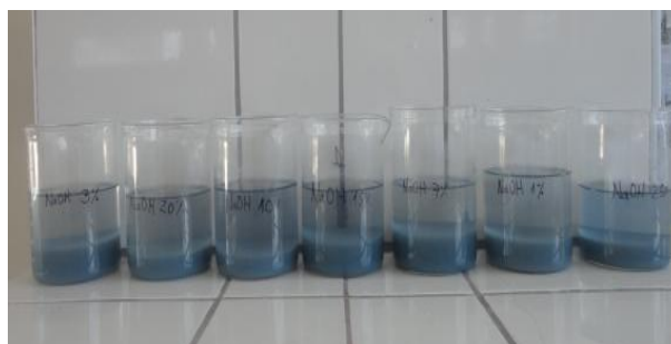
SEDIMENTACIÓN DE LAS MUESTRAS TRATADAS
