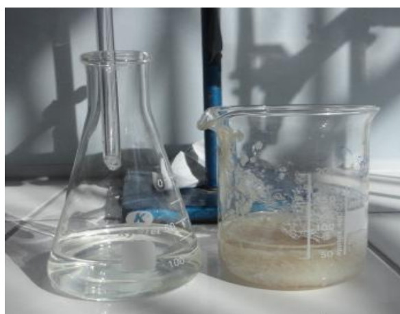
FILTRADO DEL AGUA DEL PELAMBRE
