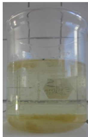
PRECIPITACIÓN DE LOS COÁGULOS CON SULFATO DE ALUMINIO
