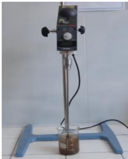
Figura 5. Instalación experimental para el ensayo de coagulación.
