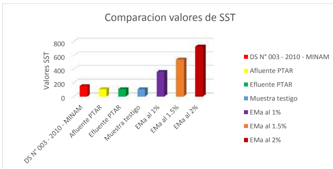
GRAFICO N° 09: Comparación remoción tratamiento con diferentes dosis de EMa con PTAR y LMP.
