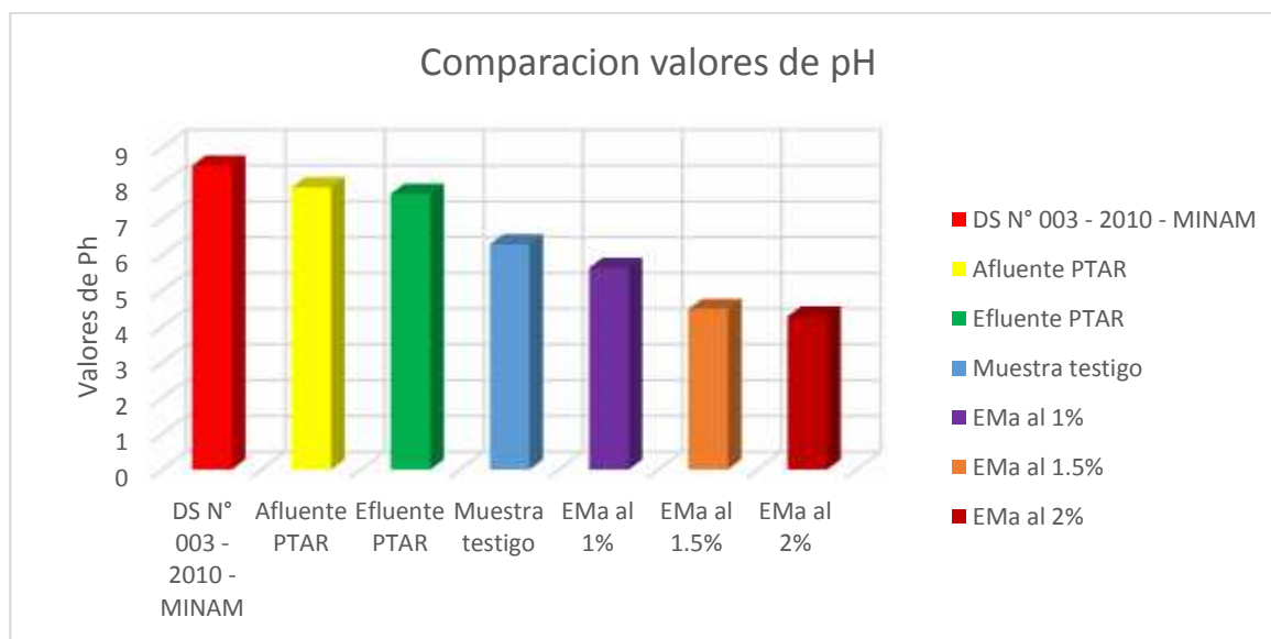
GRAFICO N° 08: Comparación remoción tratamiento con diferentes dosis de EMa con PTAR y LMP.
