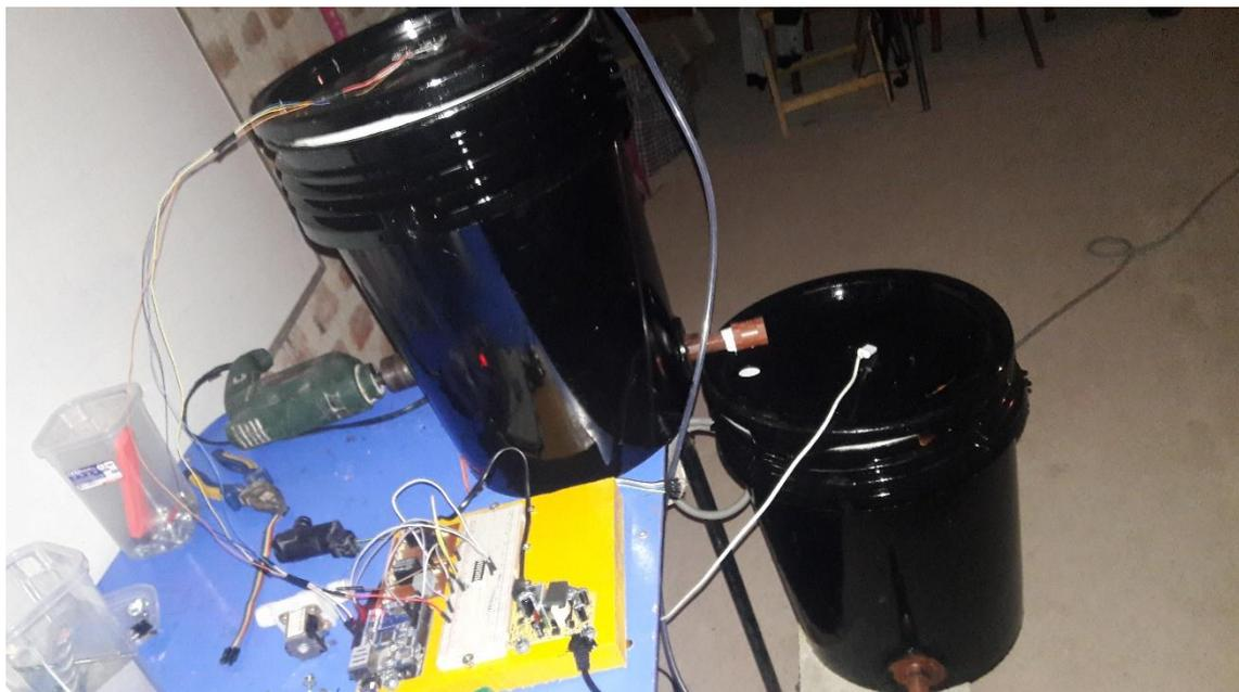
Armado de maqueta de control de nivel de agua sin el programa
