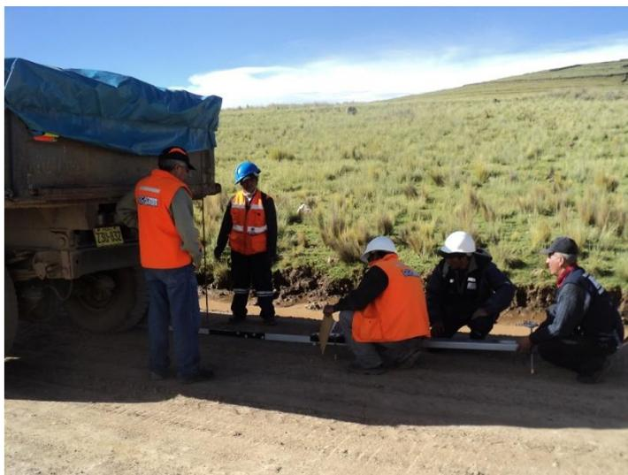
**FIGURA N° 13:** Ensayo de deflexiones (viga benckelman).
