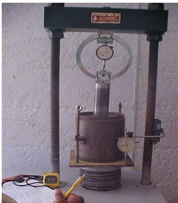
**FIGURA N° 11:** Ensayo de CBR en laboratorio.
