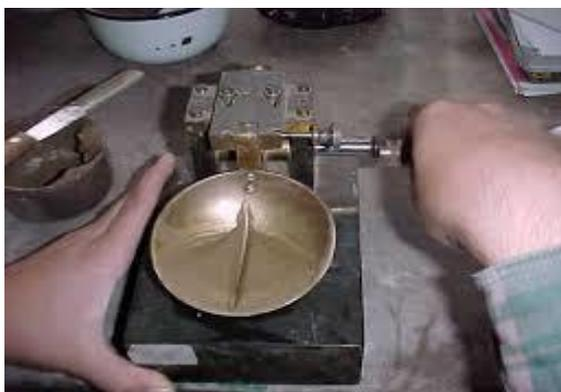
**FIGURA N° 07:** Ensayo de límite líquido en laboratorio.
