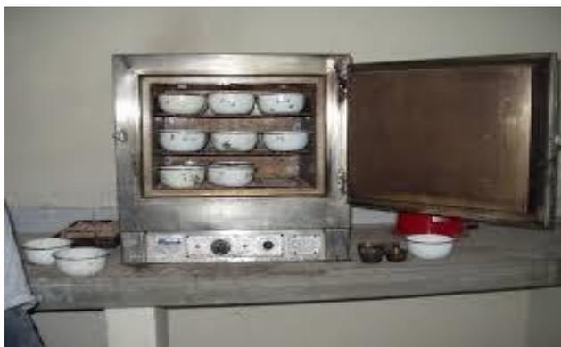
**FIGURA N° 05:** Secado de muestras para el contenido de humedad.
