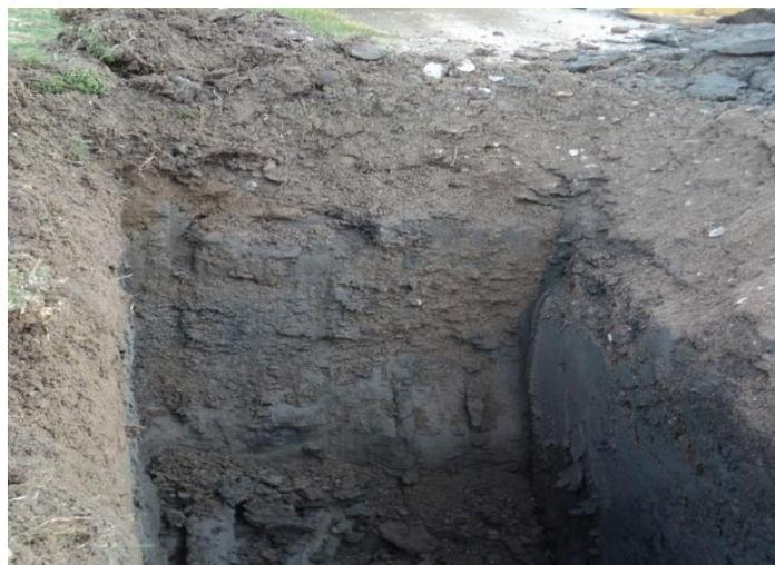
**FIGURA N° 02:** Calicata aperturada en suelos cohesivos.
