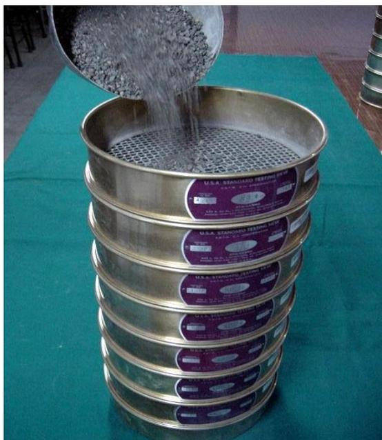
**FIGURA N° 06:** Granulometría de muestras en laboratorio.
