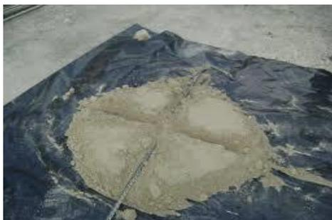
**FIGURA N° 04:** Cuarteo de muestras en laboratorio.
