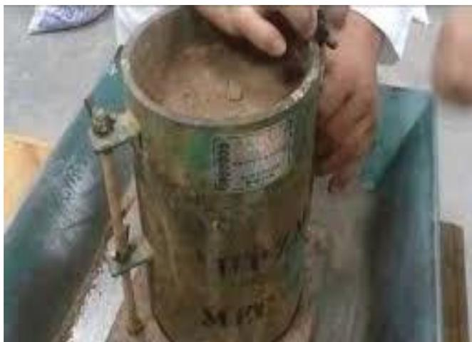
**FIGURA N° 10:** Ensayo de proctor modificado en laboratorio.
