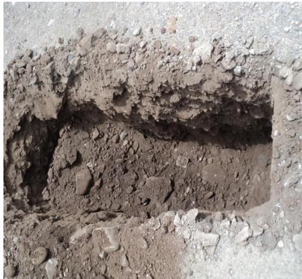
**FIGURA N° 01:** Muestra la calicata aperturada en suelos granulares.
