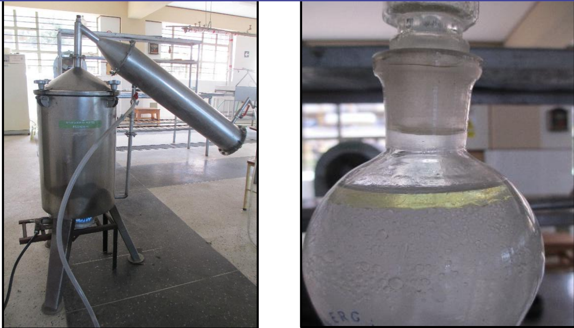
Figura 6. Extracción del aceite esencial de menta por arrastre a vapor de agua.
