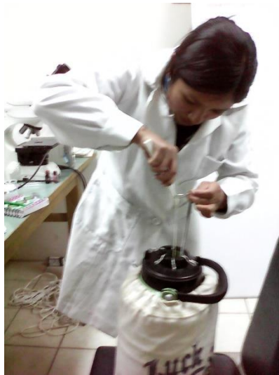
Foto 3: Extracción de la pajilla del tanque criogénico
