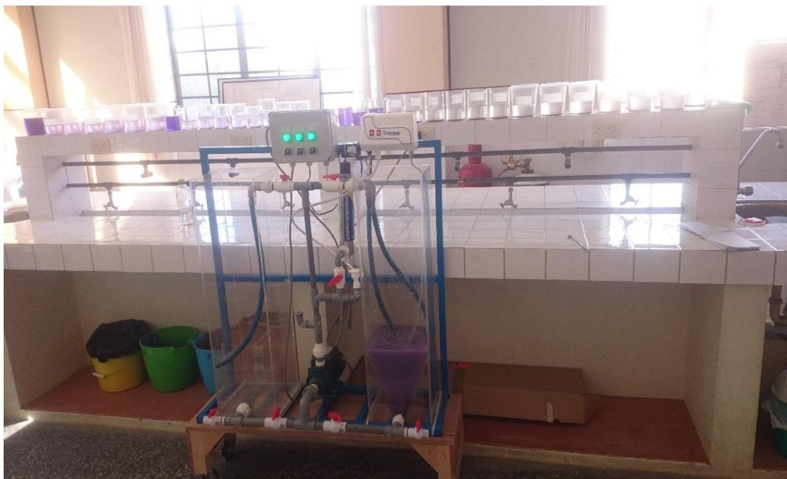
**Foto 14: Muestras de los tratamientos realizados en el equipo de procesos de oxidación avanzada (POA)**
