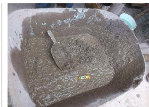
**Ilustración 50:** Termómetro rodeado con 3” de concreto como mín.
