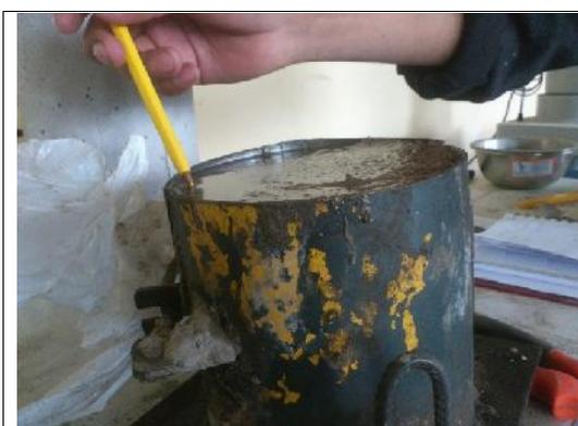
**Ilustración 56:** Se inclina el molde para extraer el agua de exudación
