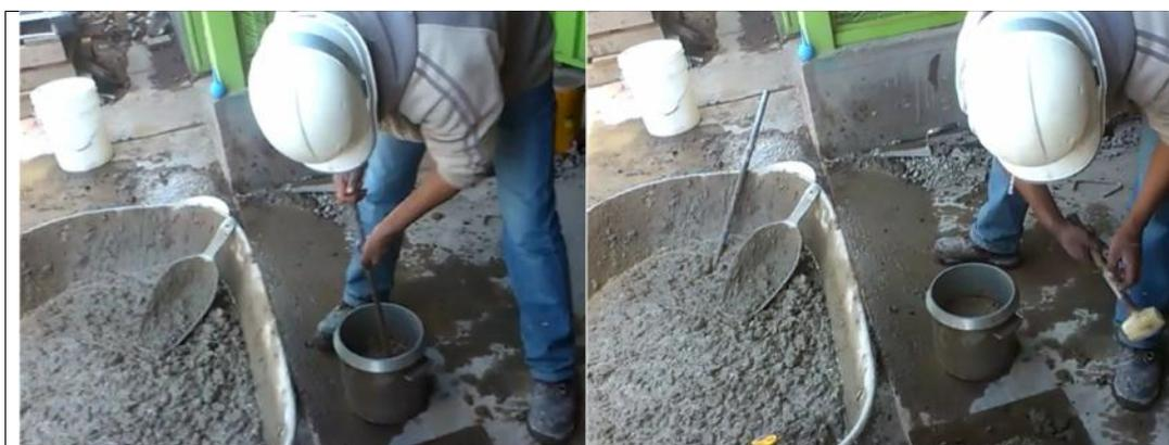
**Ilustración 41:** se compacta en 3 capas de igual volumen con 25 golpes.
