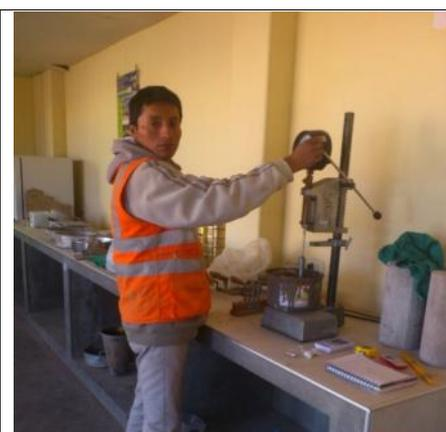
**Ilustración 59:** Se procede con el ensayo de resistencia a la penetración
