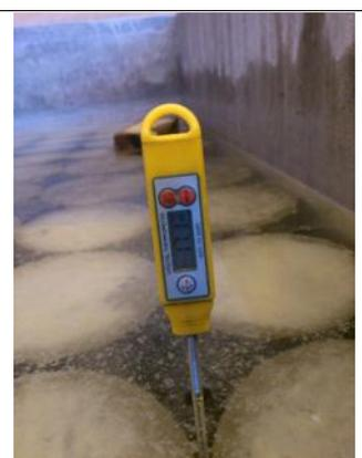
**Ilustración 64:** temperatura de la poza de curado 17.1°C
