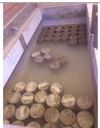
**Ilustración 62:** poza de curado con hidróxido de calcio (80gr para 0.5m3 de agua)
