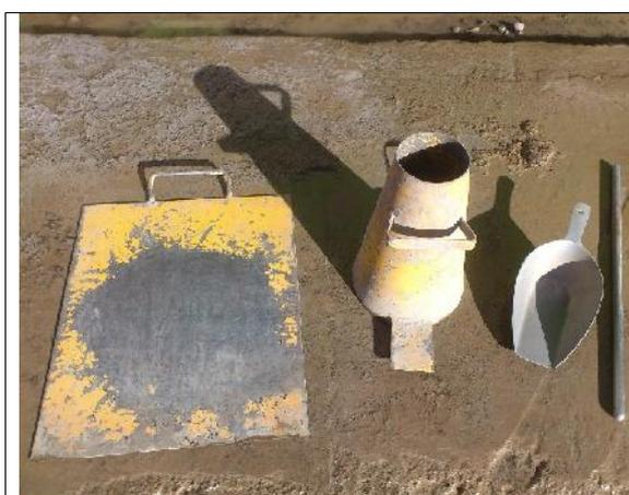
**Ilustración 23:** Equipos para realizar el ensayo de asentamiento (cono de abrams)
