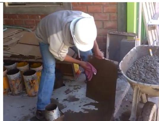
**Ilustración 25:** se humedecen los equipos para realizar el ensayo.
