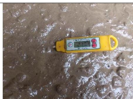
**Ilustración 51:** durante 2min. O hasta que se estabilice la lectura.
