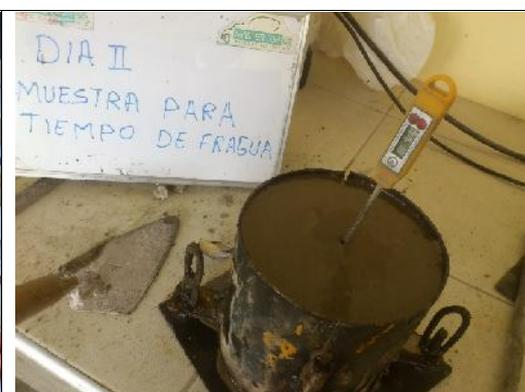
**Ilustración 57:** Se coloca el termómetro para determinar la temperatura del concreto
