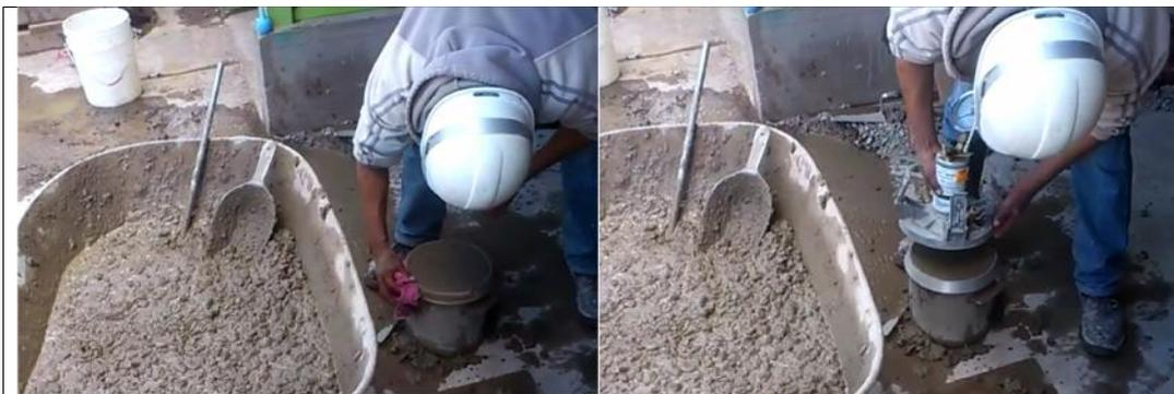
**Ilustración 43:** se realiza la limpieza del borde superior para garantizar el hermetismo.
