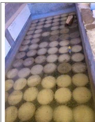
**Ilustración 61:** Poza de curado en agua con hidróxido de calcio
