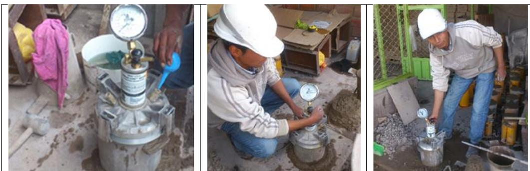
**Ilustración 45:** llenar con agua por las válvulas de paso y cerrarlas, se bombea aire hasta que el indicador este en el punto de inicio.
