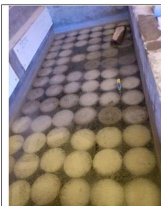
**Ilustración 63:** control de temperatura de la poza de curado
