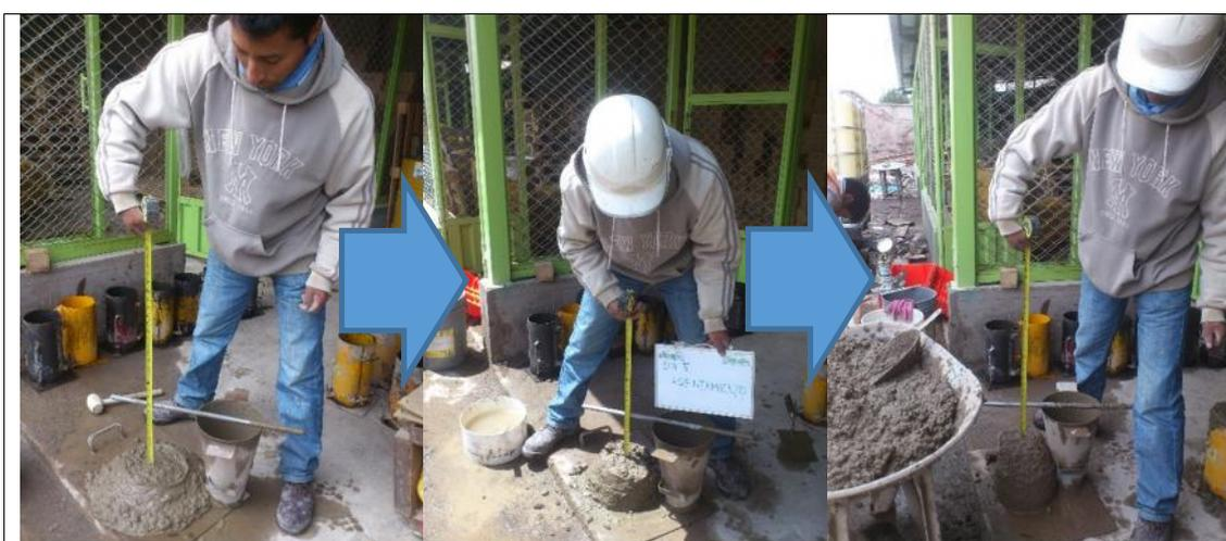
Ilustración 29: Variación del asentamiento: 09:40am Slump = 8 1/4", 10:20am Slump = 6 1/2", 11:20am Slump = 4 1/4" y 12:20pm Slump = 1 1/4".
