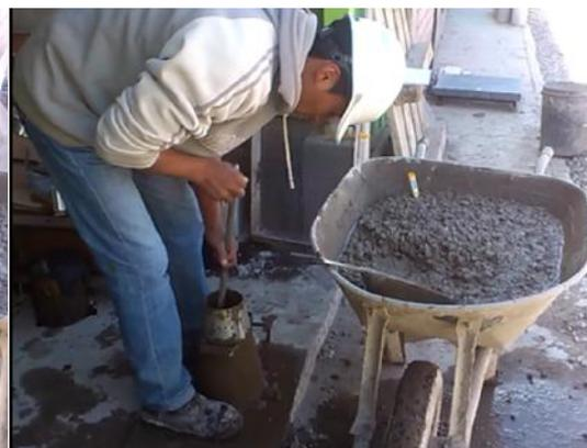
**Ilustración 26** 14: en 3 capas de igual volumen se compacta con 25 golpes inclinando la varilla en la primera capa.
