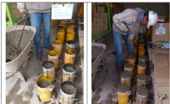
**Ilustración 34:** Compactado en 3 capas de igual volumen.
