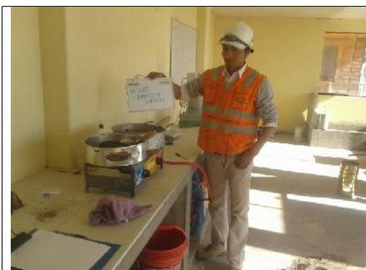
**Ilustración 17:** cocina y bandejas para el ensayo de contenido de humedad.
