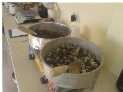
**Ilustración 18:** contenido de humedad de agregados.
