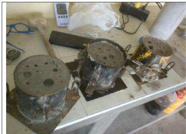
**Ilustración 60:** aplicación de la carga con las agujas a distancias de 1'' entre puntos de aplicación
