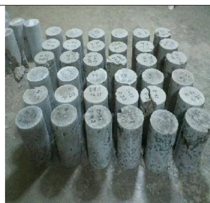
**Ilustración 53:** probetas ensayadas en los respectivos tiempos de curado.
