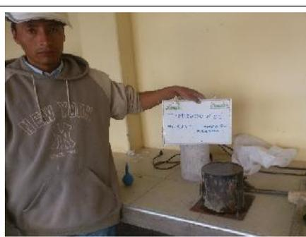
**Ilustración 55:** después del tamizado se coloca en los moldes  $H_{min}=140mm$ .
