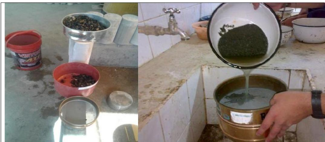
**Ilustración 11:** Recipientes en el que se lavan los agregados.
