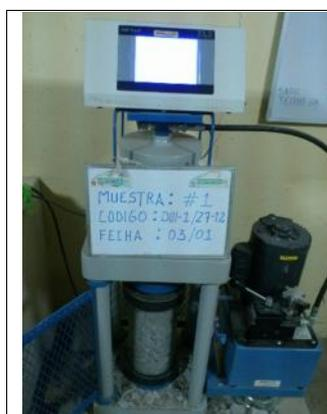
**Ilustración 52:** prensa hidráulica para el ensayo de resistencia a la compresión.
