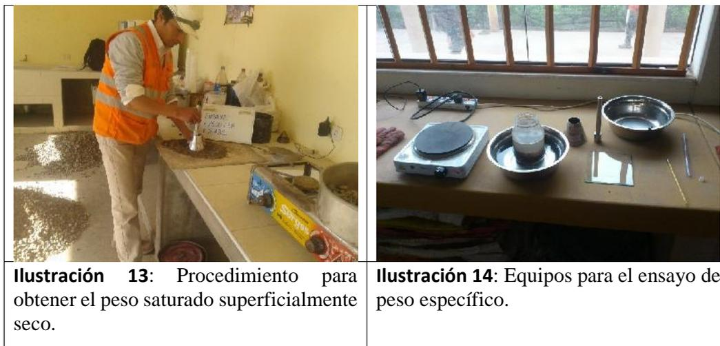
**Ilustración 13:** Procedimiento para obtener el peso saturado superficialmente seco.
