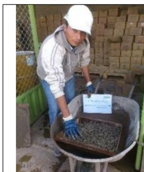
**Ilustración 54:** después del tamizado húmedo del concreto para obtener el mortero.
