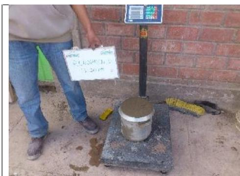
**Ilustración 38:** se determina el peso del recipiente más el concreto para luego restar el peso del recipiente.
