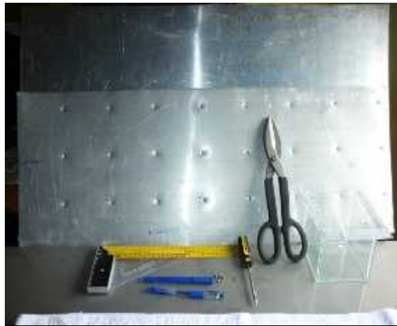
Elaboración de electrodos y celda de electrocoagulación
