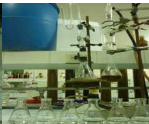
Aparato generador de arsina, depurador y adsorbedor
