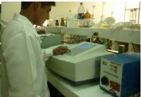
Análisis de arsénico - espectrofotometría U.V.
