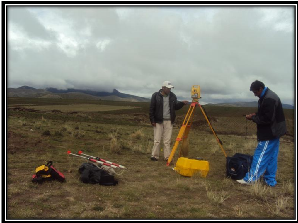
Fotografía N° 10. Ingreso de coordenadas UTM a la estación total.
