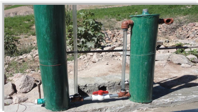
FIGURA 21. Gasómetro para medir volumen de biogás
