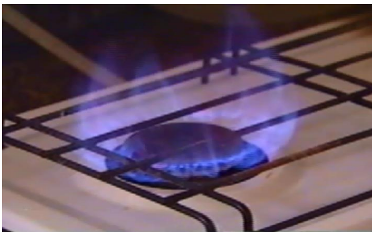
FIGURA 62. Prueba de funcionamiento de biogás.
