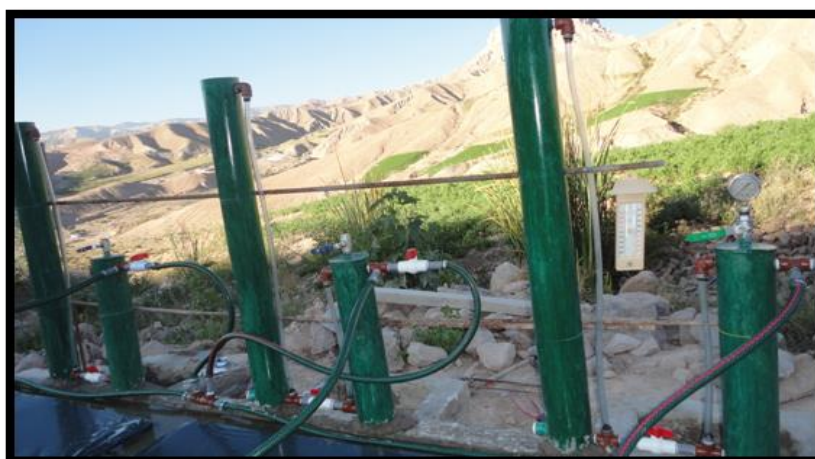
FIGURA 19. Gasómetros para medir volumen de biogás
