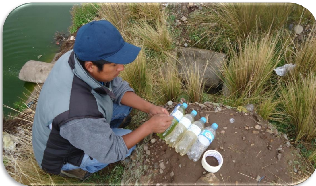
FOTO N° 05: Se observa la recolección de muestras de agua residual (Afluente y Efluente) de la PTAR de Ajoyani, luego son llevadas al Laboratorio de Ing. Química de la UNA PUNO antes de 24 horas.
