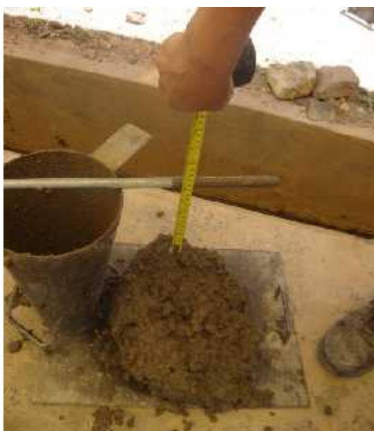
Grafico 21 Ensayo de asentamiento
