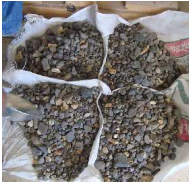
Gráfico 6 Cuarteo de agregado grueso
