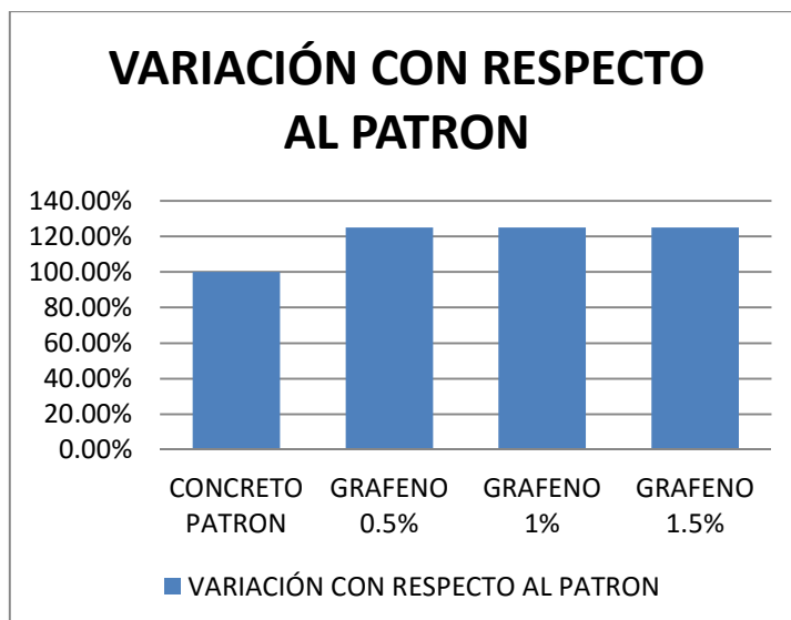
Grafico 20 Ensayo de asentamiento
