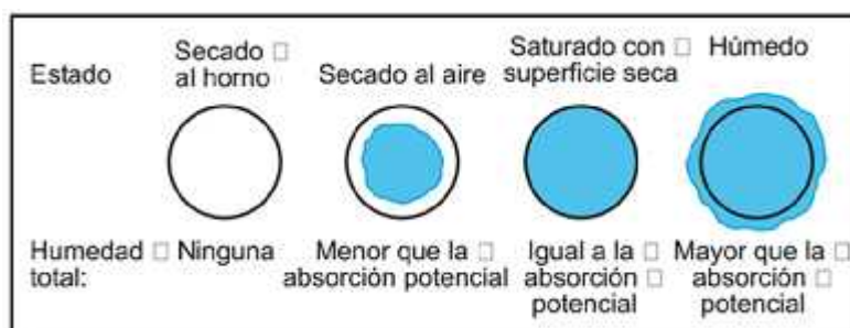
Grafico 8 Estado de humedad del agregado
