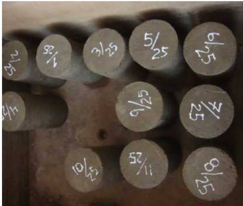
Grafico 18 Preparando el curado por inmersión
