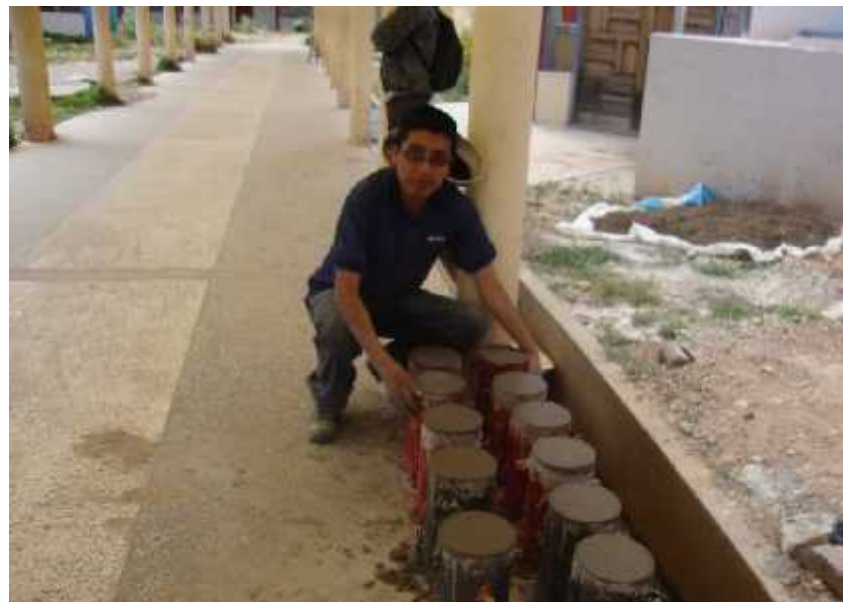
Grafico 17 Toma de muestras en briquetas
