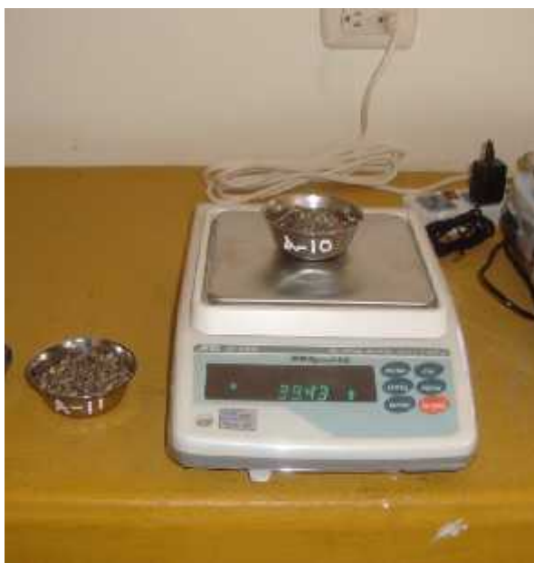
Grafico 9 Determinando el contenido de humedad
