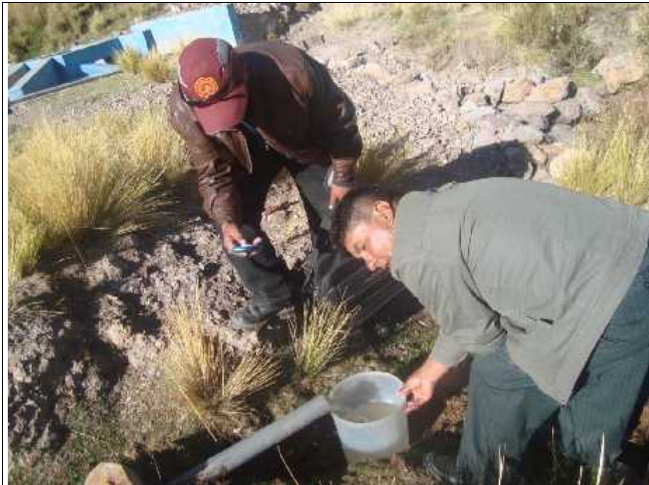
Fotografía N° 03 Trabajos de Aforo en Ojos de Agua N° 01 – MANANTIALES con el método volumétrico.
