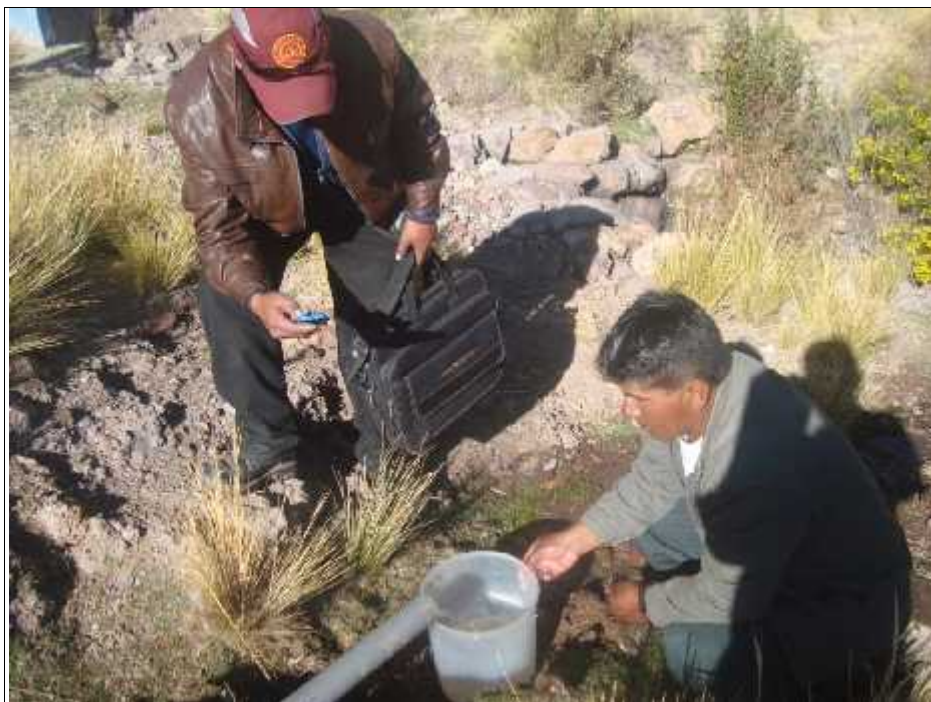
Fotografía N° 06 Trabajos de Aforo en Ojos de Agua N°04 - MANANTIALES
