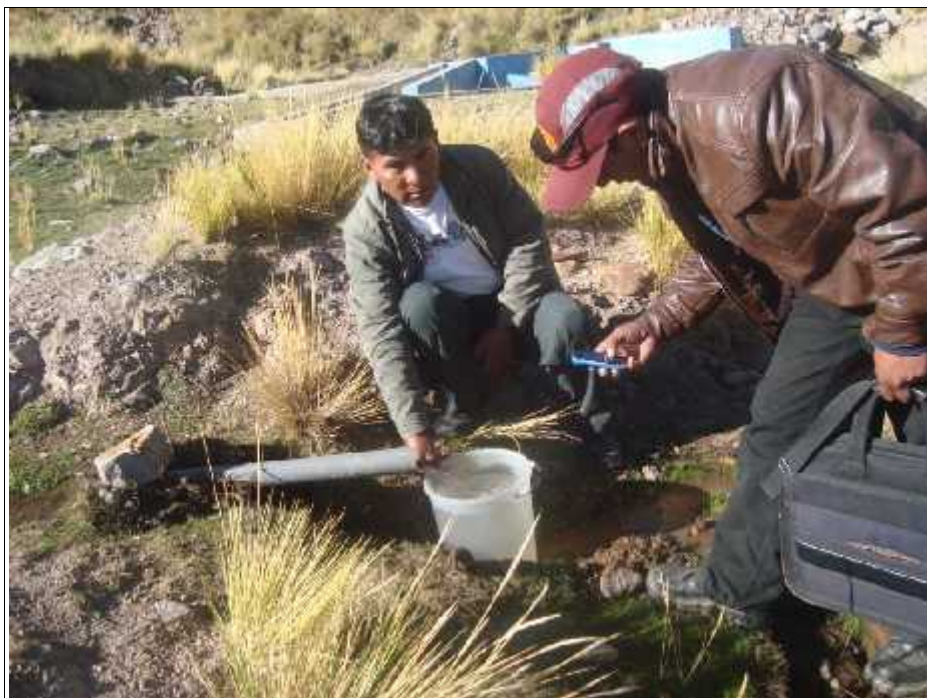
Fotografía N° 04 Trabajos de Aforo en Ojos de Agua N°02 - MANANTIALES
