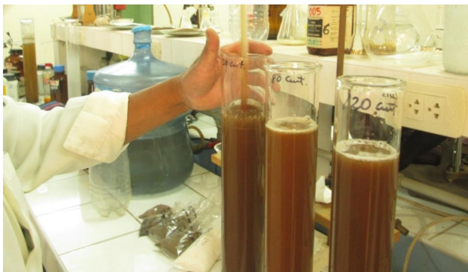
Figura 16. Sondeos realizados en la microcuenca Sasani, de izquierda a derecha; horizontes de 300mm, 800mm y 1100mm.
