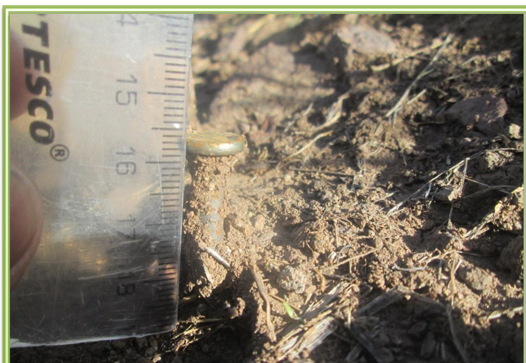
Fotografía N° 6. Erosión de 33.5 mm (3.5 mm de altura sedimentada) muestras en zonas altas con pendiente de las nueve parcelas o laderas dentro de la microcuenca Sasani ( 13-06-2014 )
