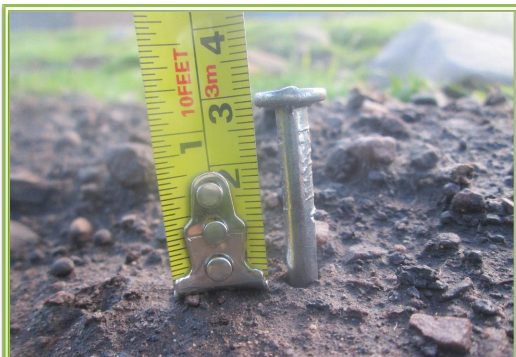
Fotografía N° 2. Medición de clavos de erosión al inicio de las tormenta a 30 mm, sobre la superficie, para el cálculo de erosión hídrica ( 27-02-2014 )
