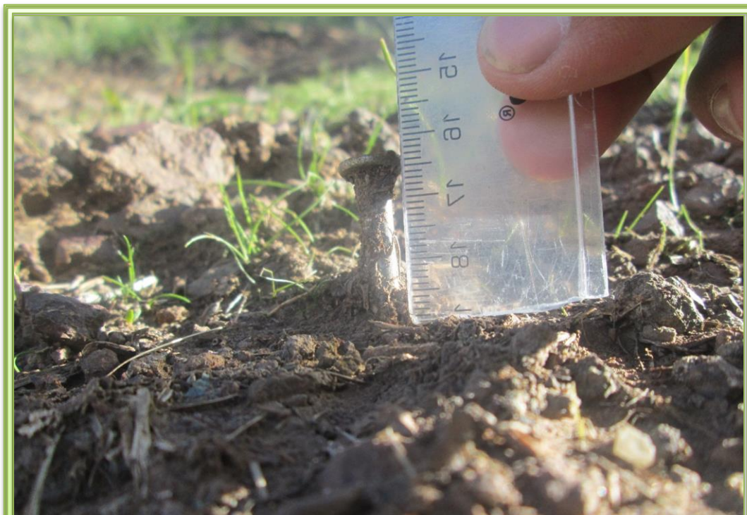
Fotografía N° 5. Sedimentación de 26.8 mm (3.2 mm de altura sedimentada) muestras en zonas bajas de las nueve parcelas o laderas dentro de la microcuenca Sasani ( 13-06-2014 )
