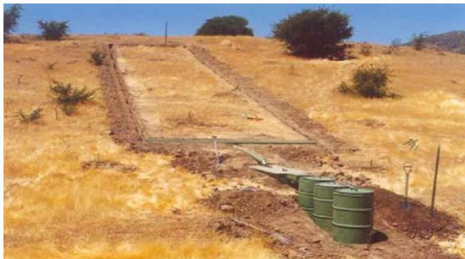
Figura 6. Parcela de escorrentía Fuente. Morgan, 1997; Yataco, 2007
