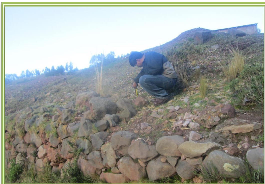
Fotografía N° 1. Colocacion clavos de erosión en diferentes puntos de la microcuenca sasani del tipo de cobertura no identificada en la etapa inicial antes de las tormentas ( 20-12-2013 )
