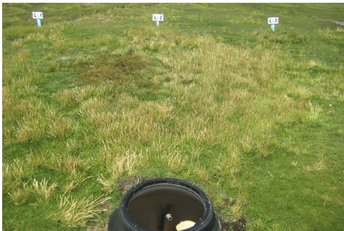
Foto 06: Vista de los Lisímetros L1, L2 y L3 y el tanque de control de lecturas.
