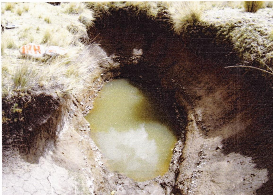
Foto N° 01.- se observa el nivel de la napa freática a menos de 1.5 metros de profundidad. Esta calicata esta ubicada en Cotaña Lapayani
