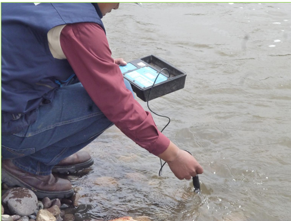
Fotografía N° 6. Medición de parámetros con multímetro en el río Cabanillas
