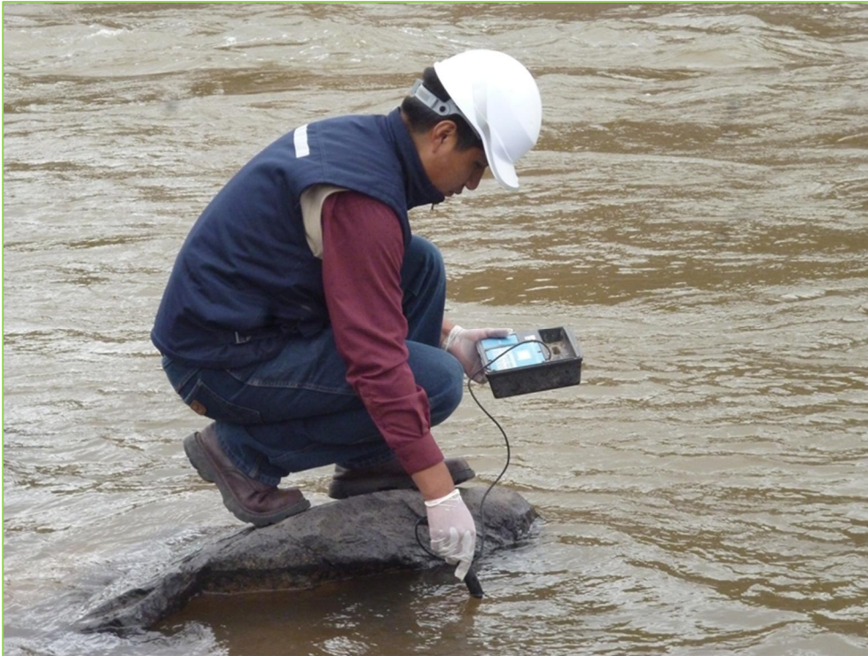
Fotografía N° 3. Medición de parámetros con multímetro en el río Cabanillas
