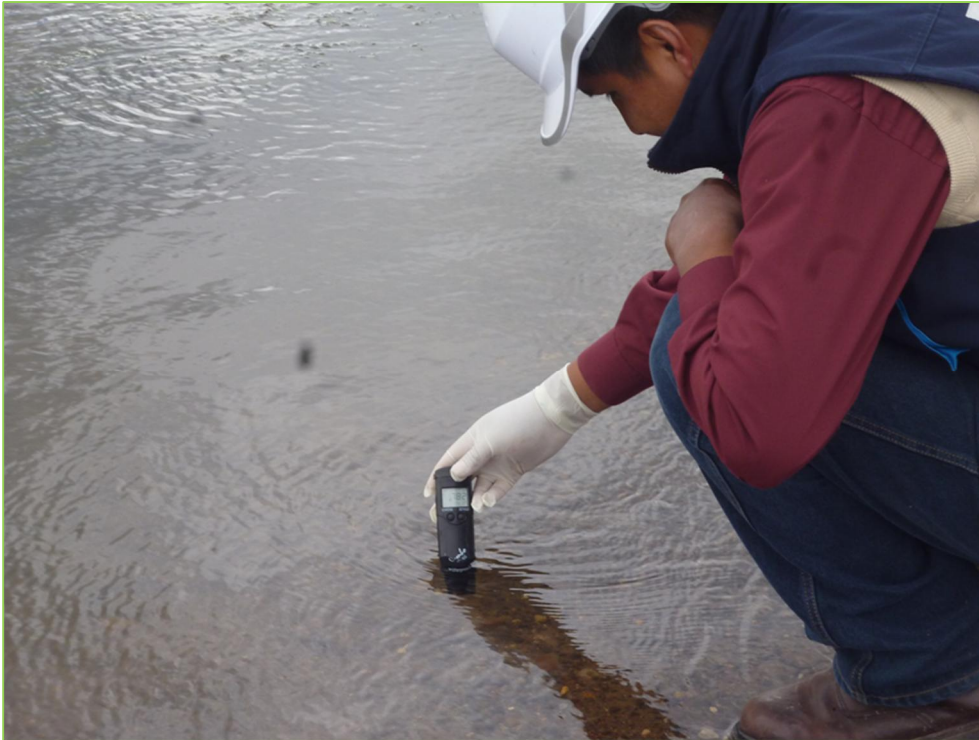
Fotografía N° 7. Medición de pH y temperatura en el río Cabanillas
