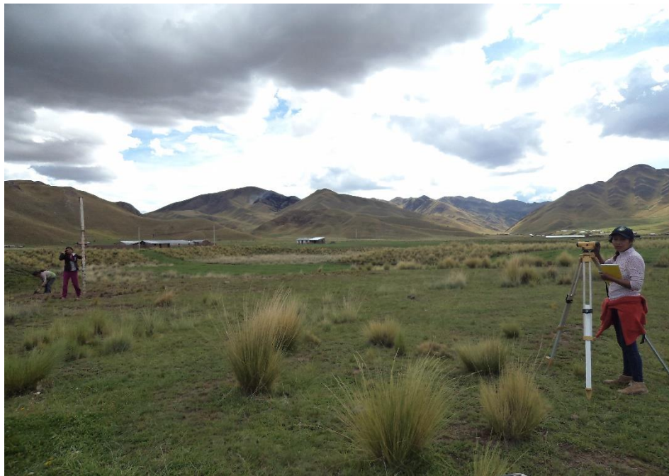
FOTO N° 01: TRABAJO TOPOGRAFICO CON NIVEL DE INGENIERO
