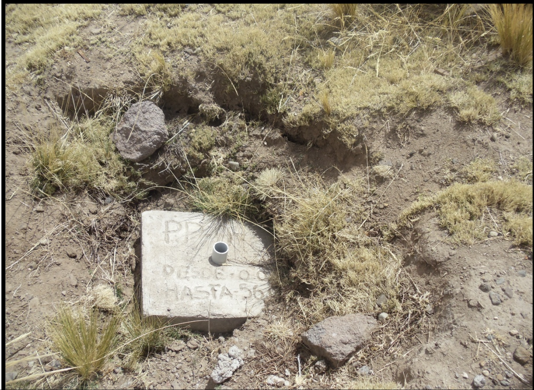
PUNTO DE PERFORACION EN EL EJE DE LA PRESA
