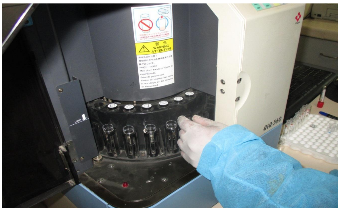
Figura 23. Proceso para la determinación de cortisol Analizador Automático de Inmunoensayos TOSOH - AIA 360. Clínica Americana, Distrito de Juliaca, octubre 2016.
