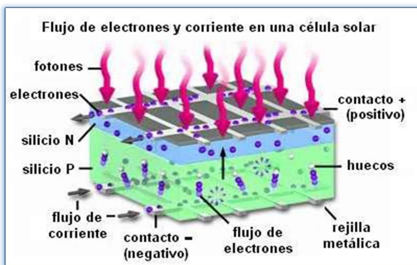
Figura 8: Principios de conversión fotovoltaica.
