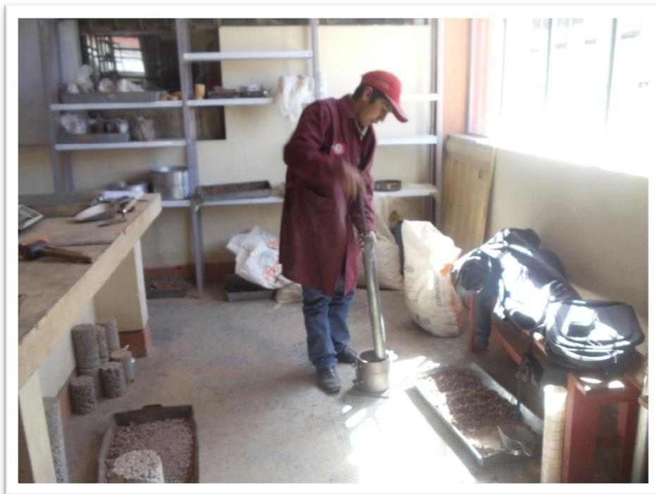
Fotografía 12: Realizando el ensayo de Proctor Modificado
