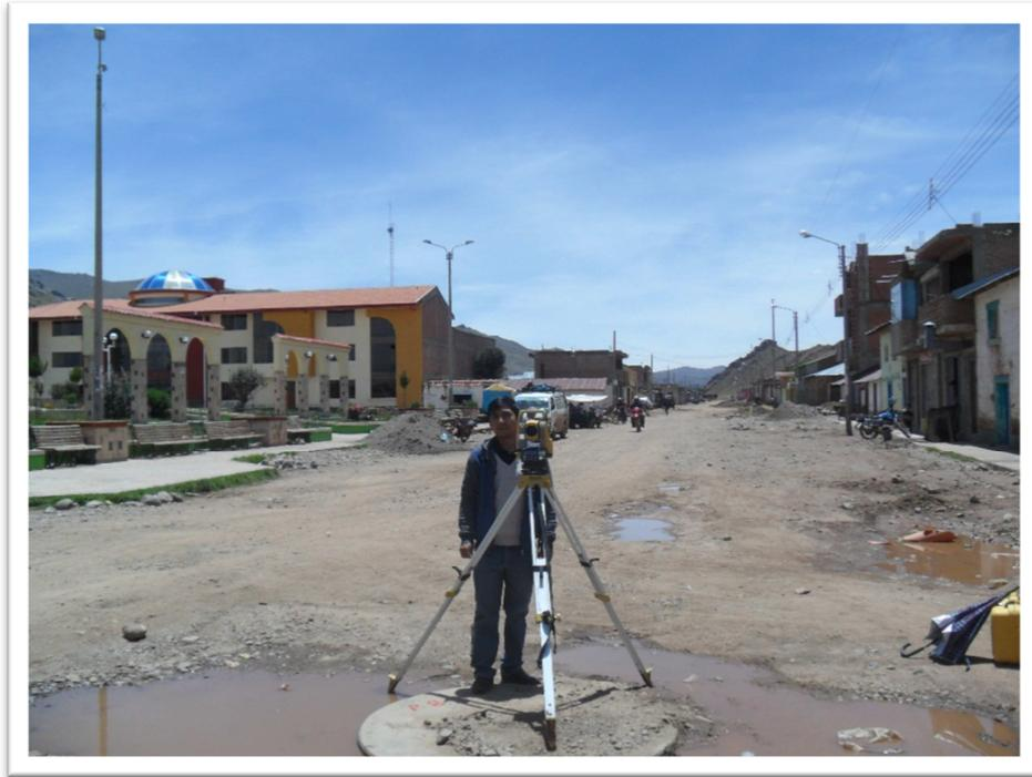
**Fotografía 01:** Levantamiento topográfico en la avenida Túpac Amaru – Llalí
