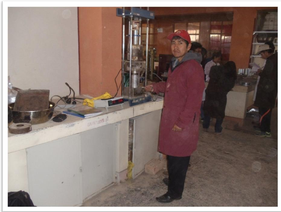
**Fotografía 15:** Realizando el ensayo de C.B.R.
