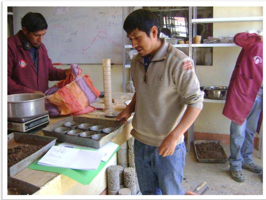
**Fotografía 09:** Realizando el ensayo de contenido de humedad de la muestra de suelo.
