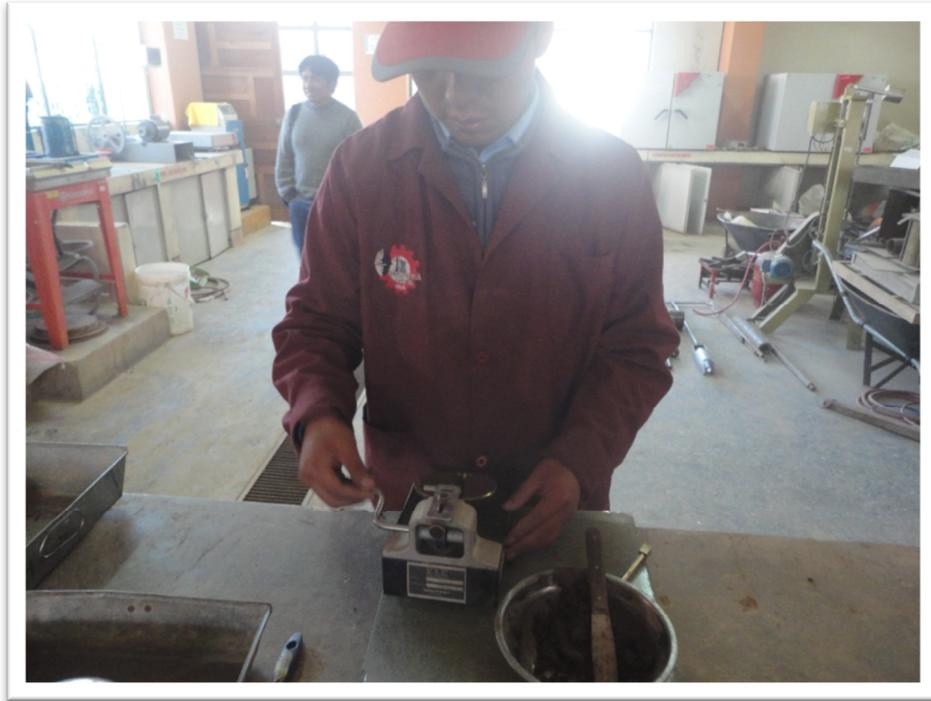
**Fotografía 07:** Realizando el ensayo de Limite Liquido en la cuchara de Casagrande.
