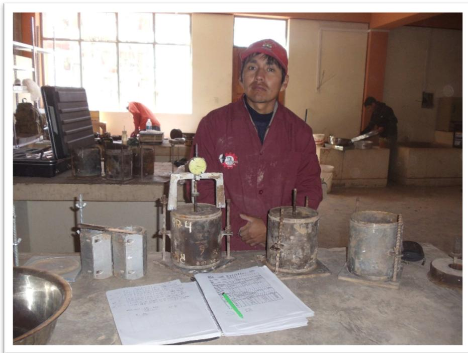
**Fotografía 14:** Muestra saturada para el ensayo de C.B.R.
