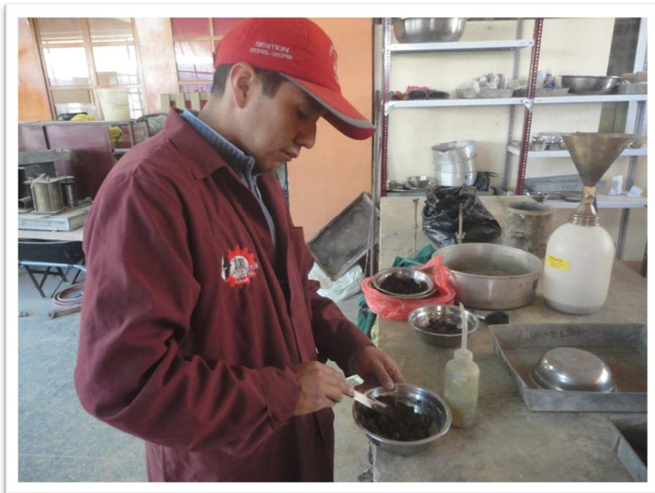
**Fotografía 08:** Realizando el ensayo de Limite Plástico
