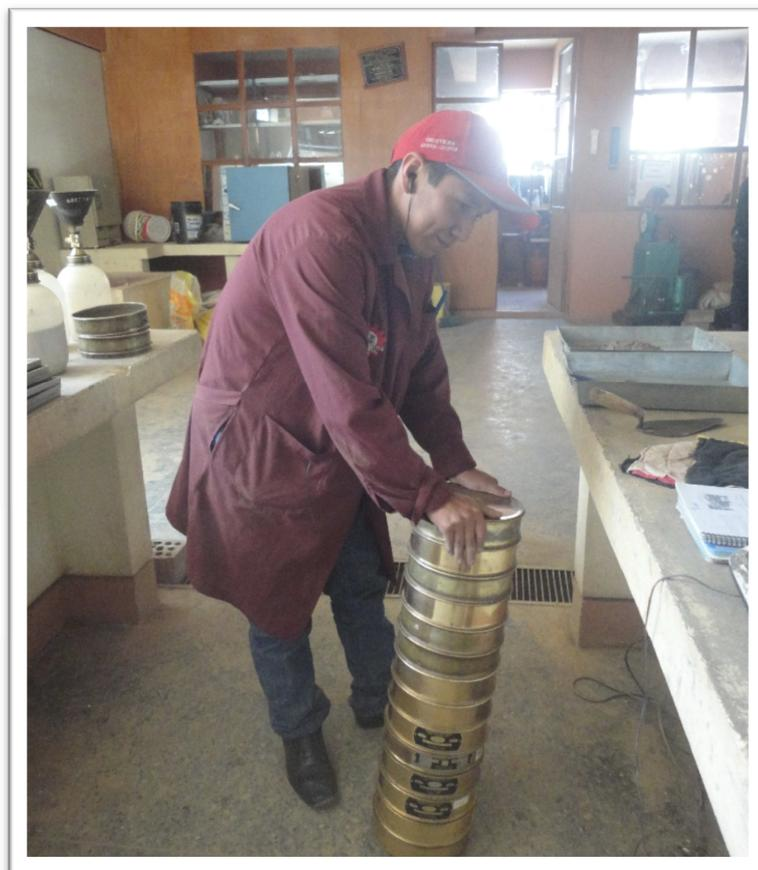
**Fotografía 10:** Realizando el ensayo de granulometría.
