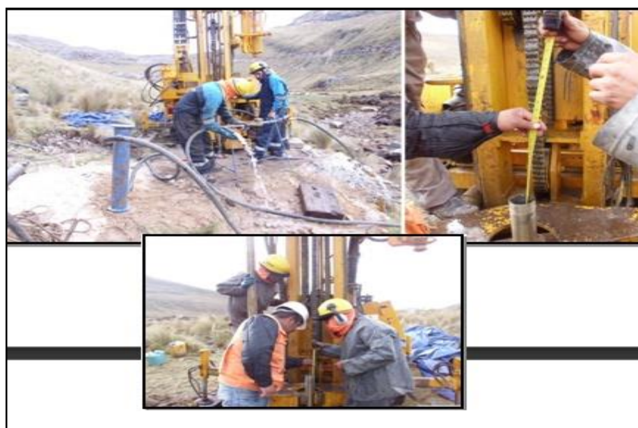
Figura N° 28: Ensayos de permeabilidad tipo Lefranc.
