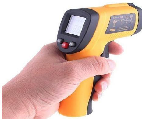
Figura 29: termómetros laser
