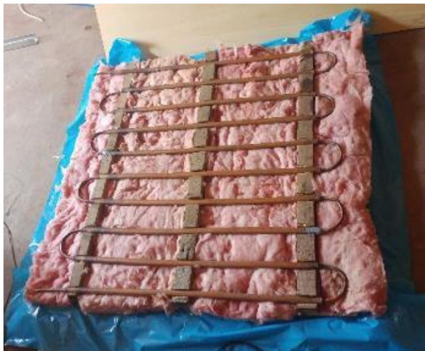
Figura N°A9: Presentación del tubo de cobre con sus aislantes
