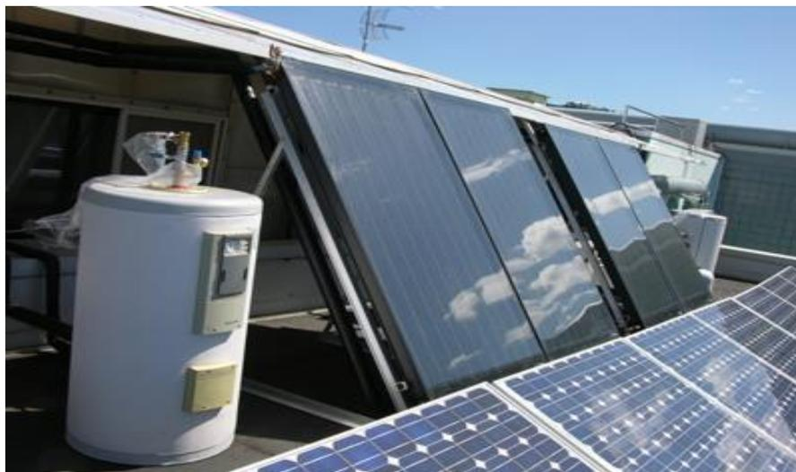
Figura 5: Montaje experimental de los dos sistemas idénticos de depósito de ACS conectado al colector solar, donde uno de ellos integra PCM
