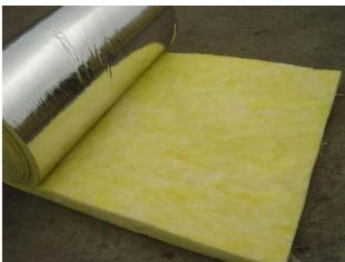
Figura 33: Fotografía del rollo de lana de vidrio
