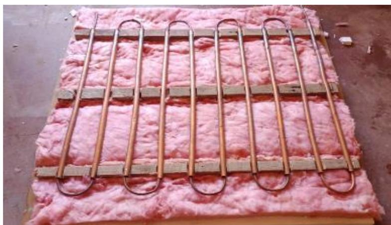
Figura 25: Aislantes Térmicos del prototipo del piso radiante
