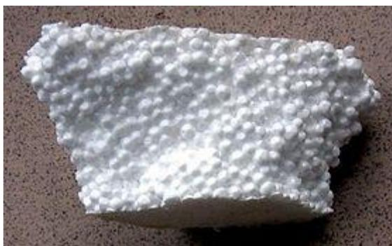
Figura 32: Fragmento de Poliestireno expandido
