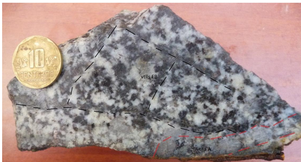
Figura N° 51: Se observan vtlls tipo EB (líneas color negro) cortada por una vetilla tipo A (vtlla de qz sinuoso, con Mo en los bordes por posible reapertura).
