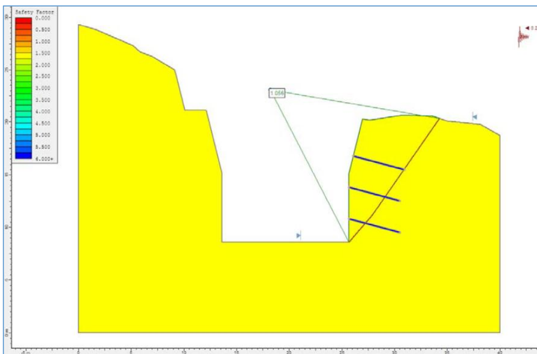
Figura 24. Análisis de estabilidad global en condiciones pseudoestáticas, con pernos de anclaje de 4 m espaciado a 2.5 m.
