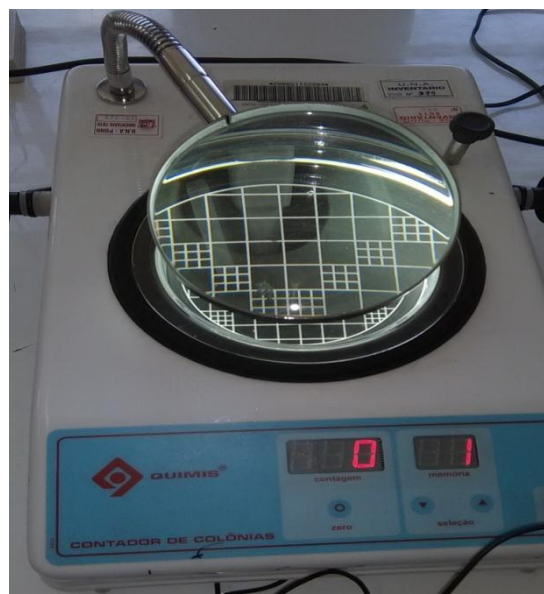
FIGURA N° 55: Lector de colonias electrónico del Laboratorio de microbiología de la Facultad de Ciencias Biológicas
