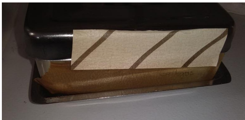
FIGURA N° 23: Lectura del indicador químico externo en el instrumental después de la esterilización
