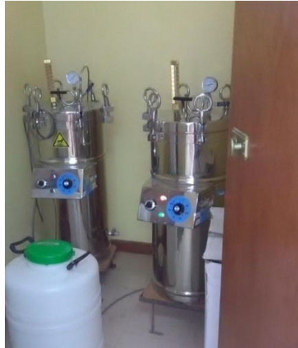
FIGURA N° 31: Autclave del laboratorio de la microbiología de la Facultad de Ciencias Biológicas
