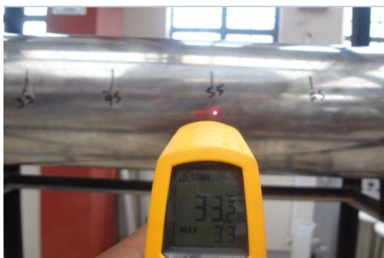
Figura 28: Obtencion de datos con termometro laser.
