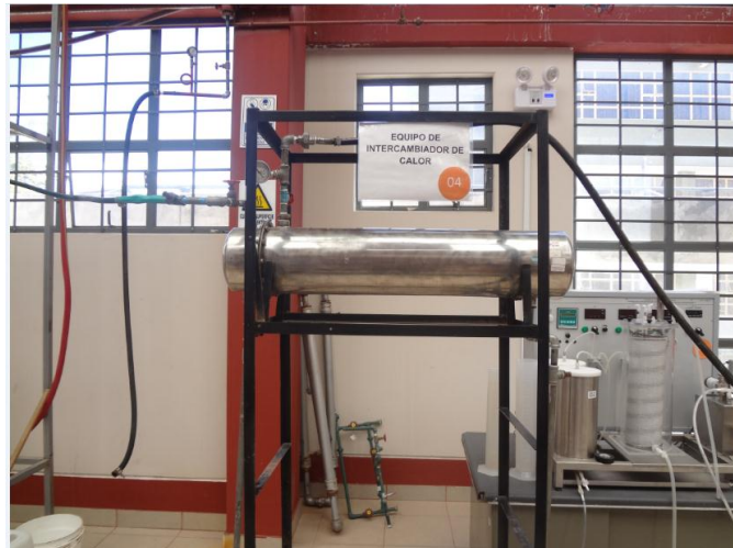
Figura 26: Vista externa del intercambiador de calor. Con permiso de la F.I.Q. UNA- Puno (Pampa, 2001).
