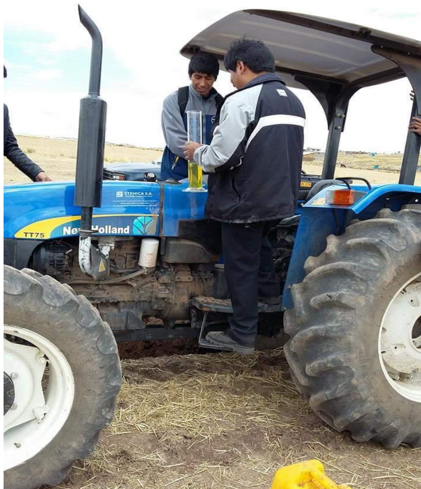
Figura 15. Medición del consumo de combustible en tractor 2
