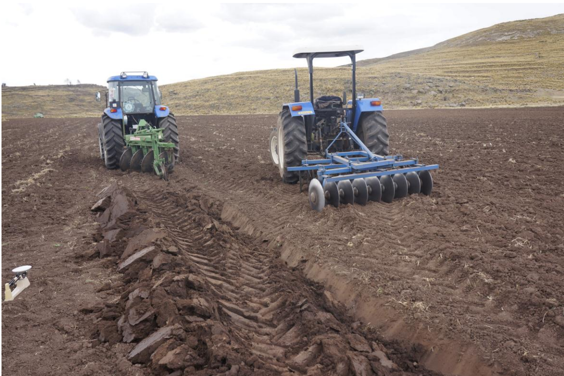
Figura 11. Tractores en pruebas de campo para medir la compactación del suelo
