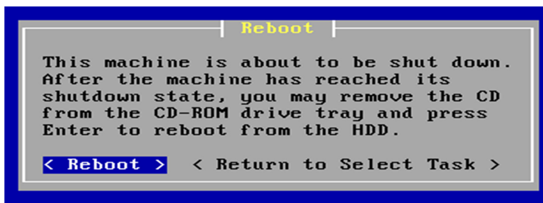
Figura 58: Reiniciando el sistema, Pfsense ya está instalado.
