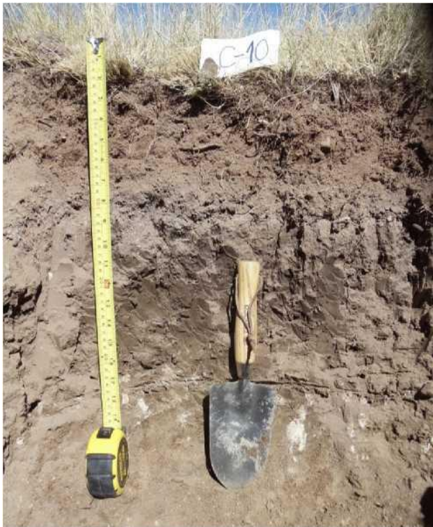
Perfil modal de la serie Laya (LY), suelo moderadamente profundo, con horizonte Bw
