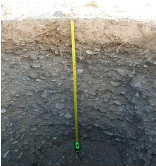
Perfil modal de la serie Calapuja superficial (CS) Con sub suelo con gravoso.
