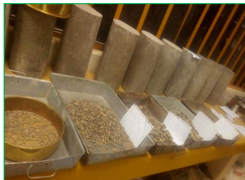
Figura 3.15: Se observa el tamizado del agregado grueso.
