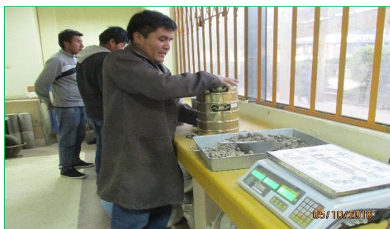
Figura 3.6: Se observa el tamizado del agregado fino.
