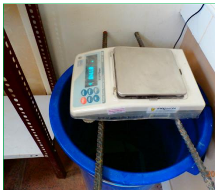
Figura 3.27: Ensayo de porosidad.
