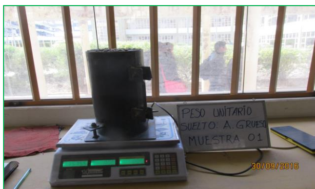
Figura 3.18: Pesado de agregado grueso para el cálculo del peso unitario.
