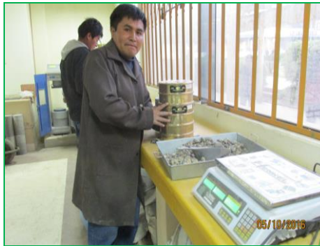
Figura 3.14: Tamizado del agregado grueso.
