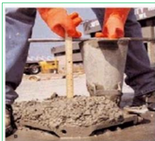
Figura 2.15: Prueba de consistencia
