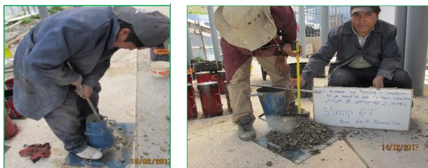
Figura 3.25: Ensayo de asentamiento cono de Abrams.
