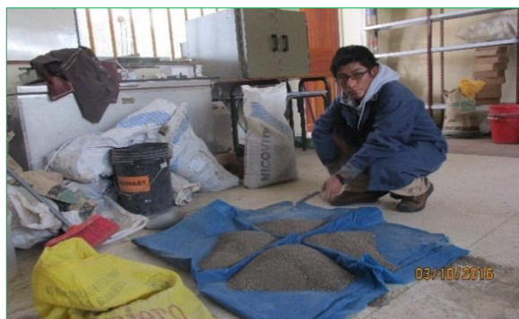
Figura 3.5: Se observa el agregado fino al momento de realizar el cuarteo.
