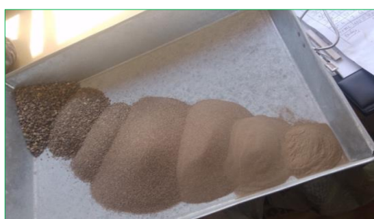
Figura 3.7: Después del tamizado del agregado fino
