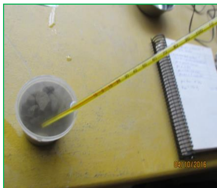
Figura 3.17: Control de temperatura del agua.
