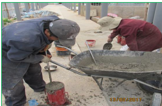
Figura 3.21: Llenado de moldes y apisonado de mezcla de concreto en tres capas iguales.
