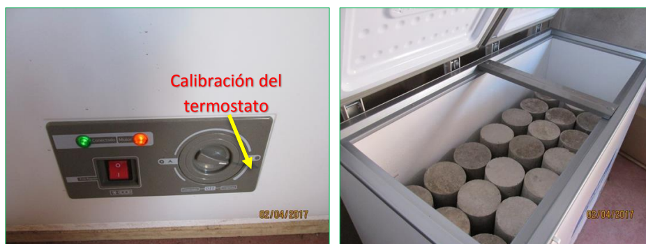
Figura 3.28: Calibración del termostato y probetas en la cámara climática.
