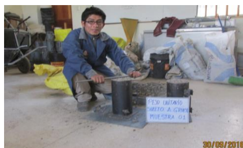
Figura 3.12: Enrasado y pesado del recipiente con la muestra para el cálculo del Peso Unitario Suelto.
