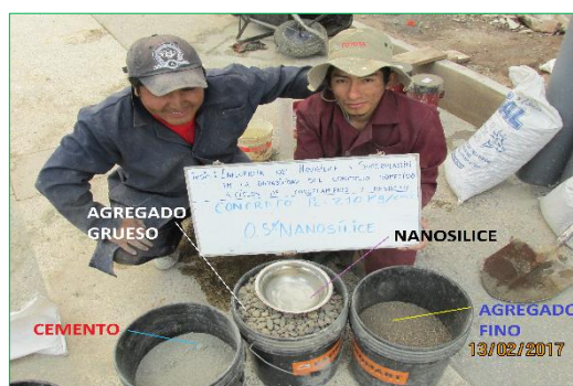
Figura 3.1: Materiales usados para la fabricación del concreto.
