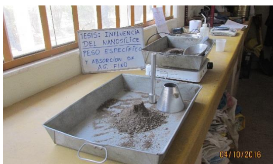
Figura 3.10: Arena superficialmente seca después del apisonado.
