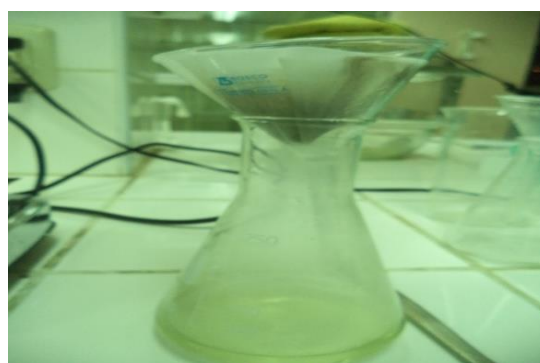
Figura A.24: Filtrado del hidrolizado
