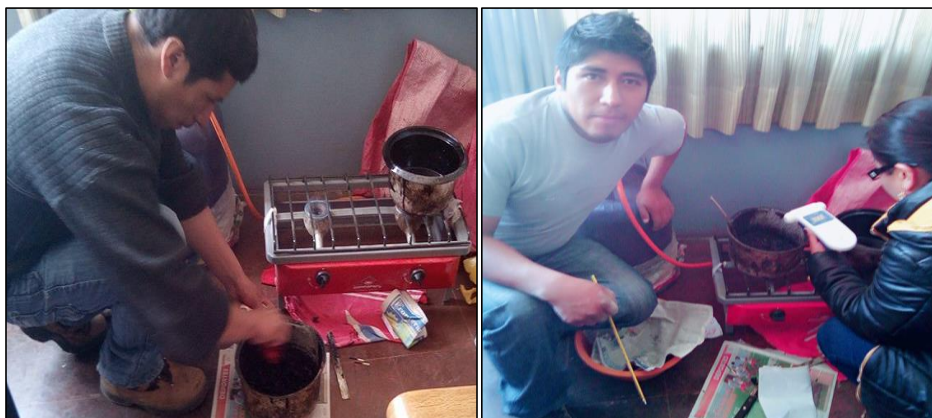
Figura N° 4. 16. Preparación y Medición de Temperatura de Mezclas Asfáltica
