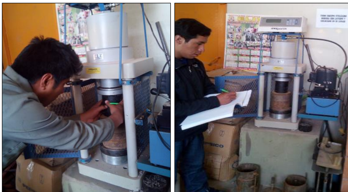
Figura N° 3. 33. Lectura de la Resistencia a la Compresión Simple
