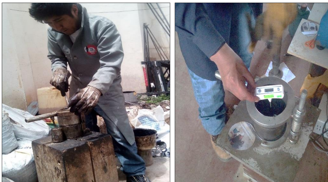
Figura N° 3. 19. Medición de Temperatura y Chuseado de Mezcla Asfáltica
