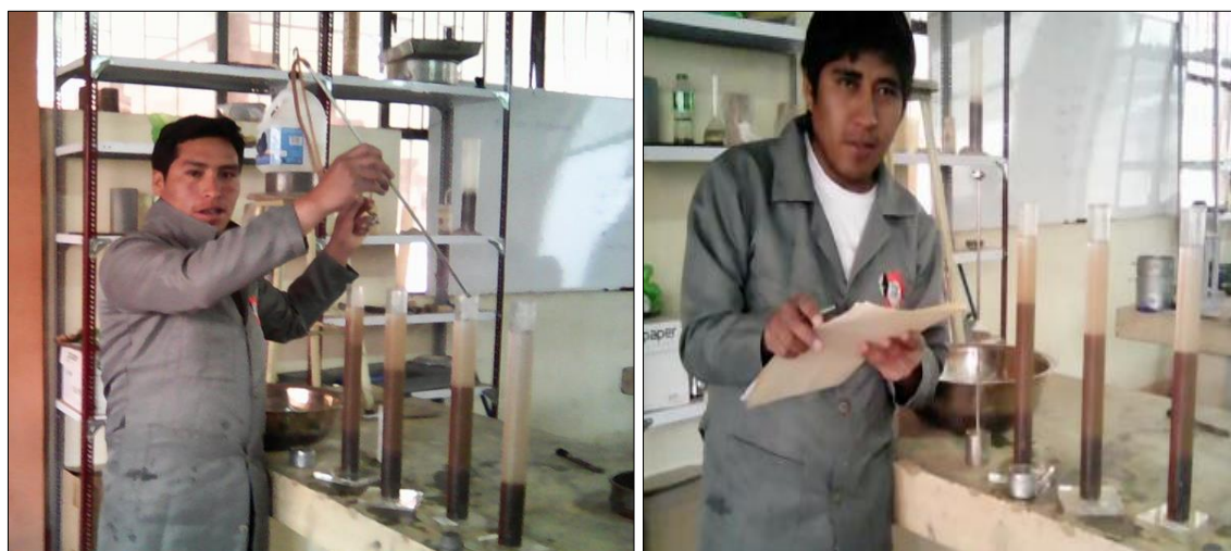
Figura N° 3. 14. Ensayo de equivalente de Arena del Agregado Fino
