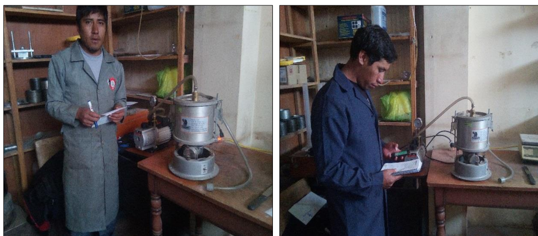
Figura N° 3. 29. Remoción del aire atrapado a 30 mm de Hg durante 5 -15 minutos
