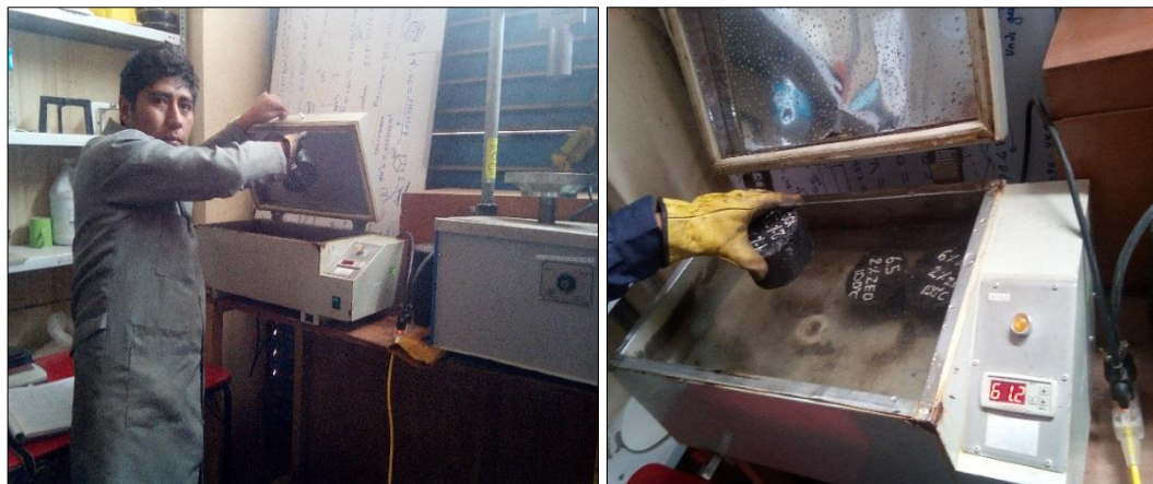
Figura N° 3. 26. Colocación de Especímenes en Baño de Agua a 60 \pm 1^\circ\text{C} durante 30 min
