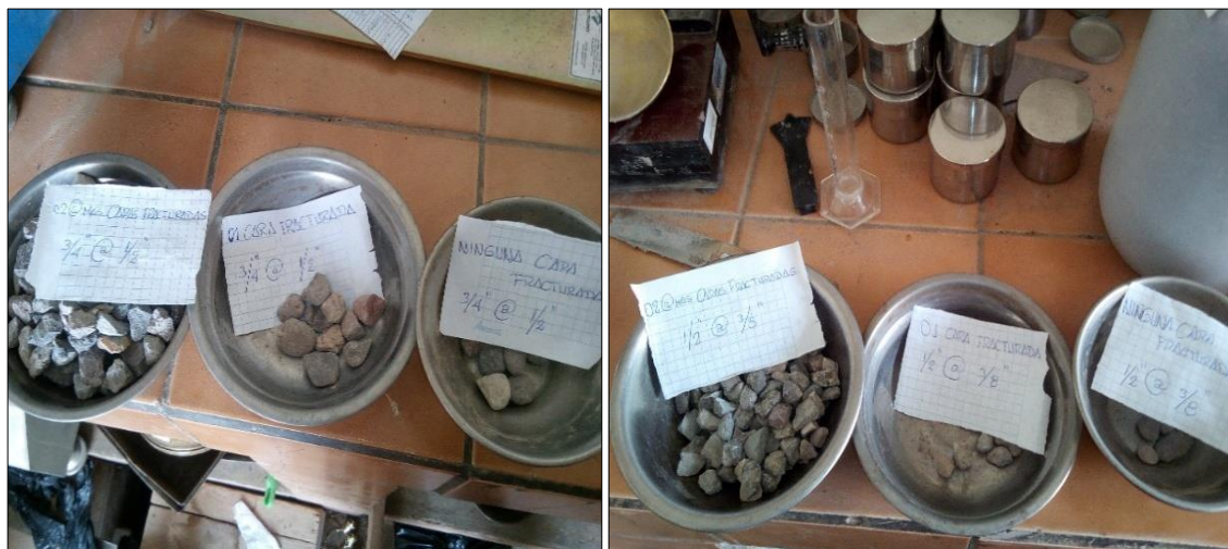
Figura N° 3. 11. Selección de Una y Dos o Más Caras Fracturadas
