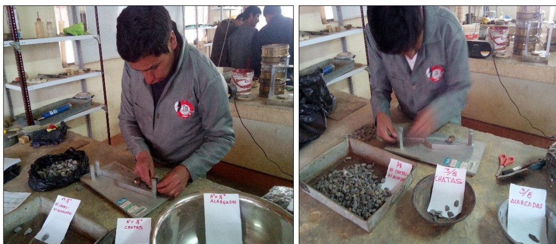
Figura N° 3. 12. Partículas Chatas y Alargadas de la Piedra Chancada
