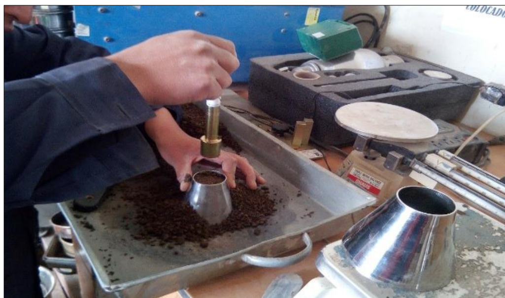
Figura N° 3. 5. Molde Cónico y Golpes a la Superficie Suavemente
