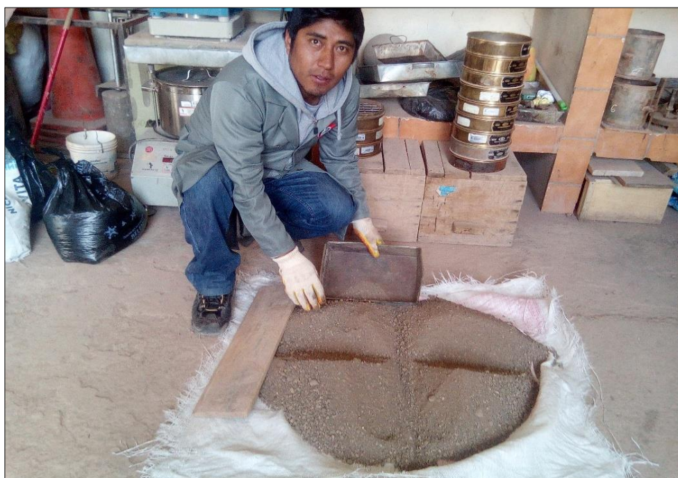
Figura N° 3. 3. Selección de la Muestra Representativa
