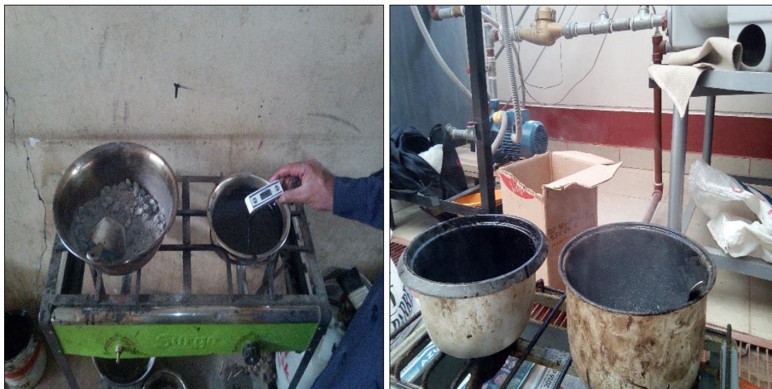
Figura N° 3. 17. Calentamiento de Agregado y Asfalto a 140°C y 100°C
