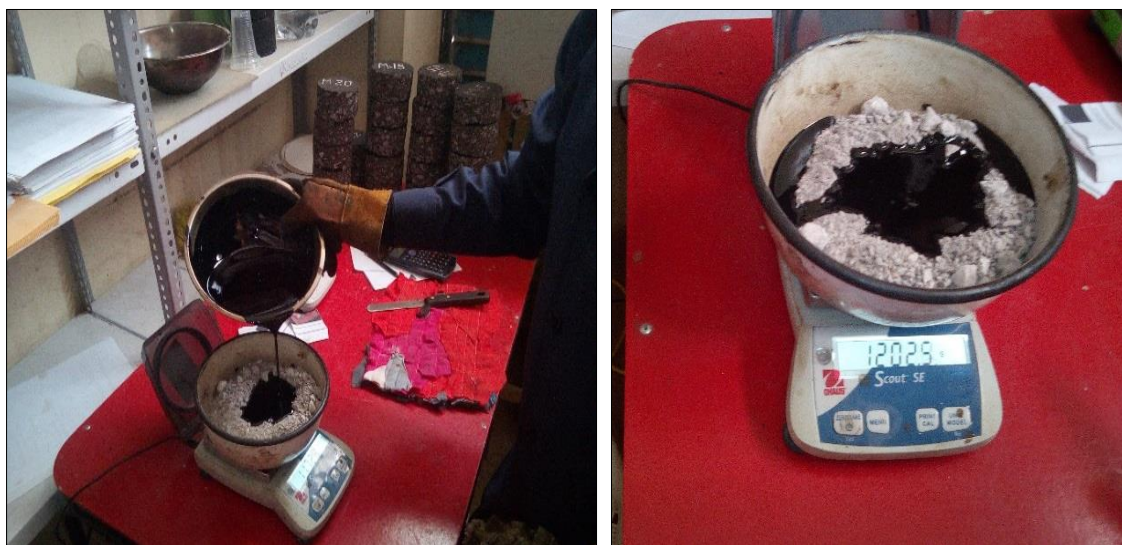
Figura N° 3. 18. Mezcla de Agregado, Filler y Asfalto
