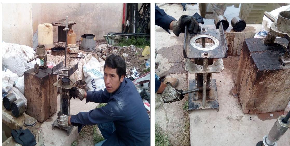
Figura N° 3. 21. Extracción de Especímen con Gata Hidráulica
