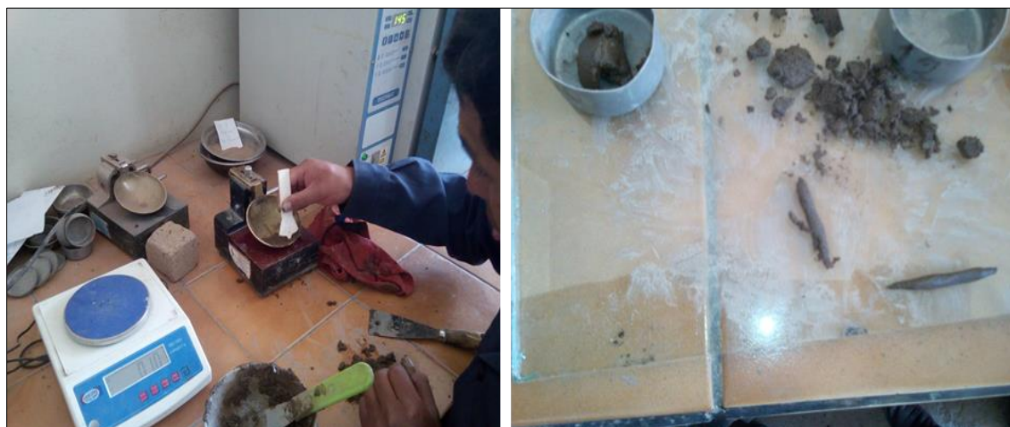
Figura N° 3. 13. Ensayo de los límites de ATTEBERG
