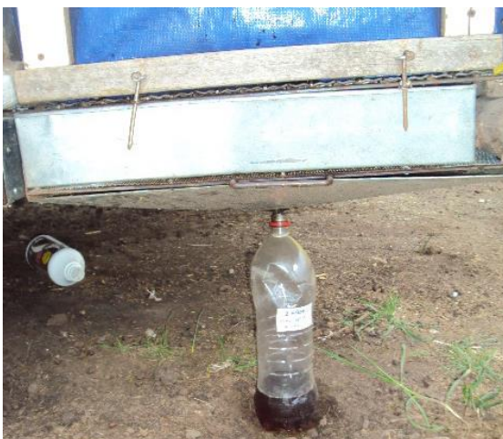
FOTO 7: Dispositivo colector de orina y heces, embudo colector de orina.
