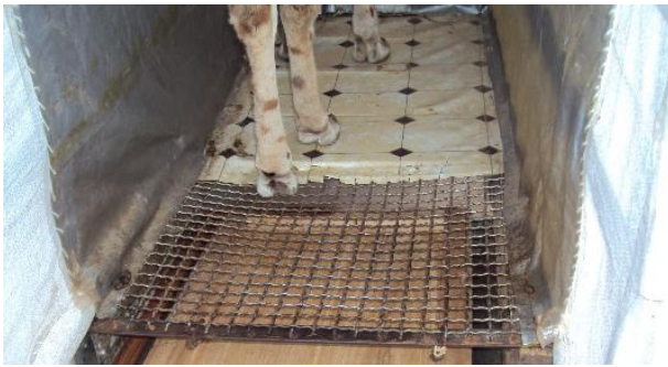
FOTO 6: Dispositivo colector de orina y heces, parrilla de coleccion de heces.
