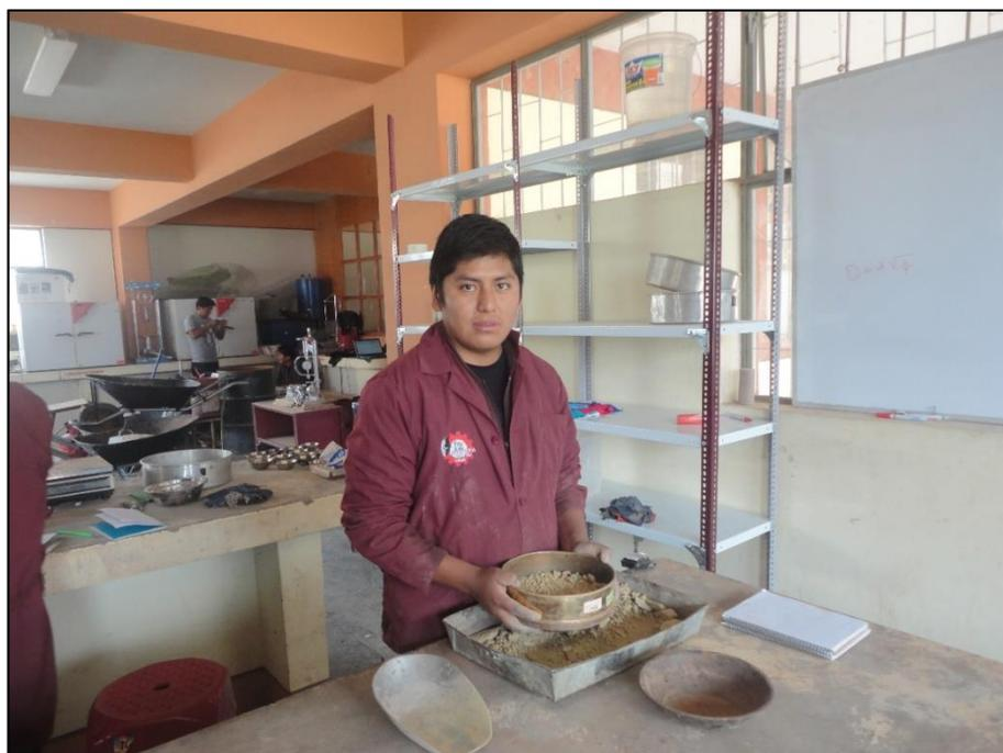
**Figura F.32.** Tamizado de la muestra por la malla N°40
