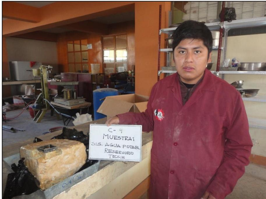
**Figura F.27.** Tallado de muestra en molde para ensayo de Corte Directo
