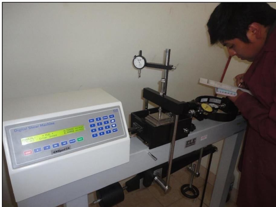
**Figura F.28.** Muestra inalterada sometida a corte directo
