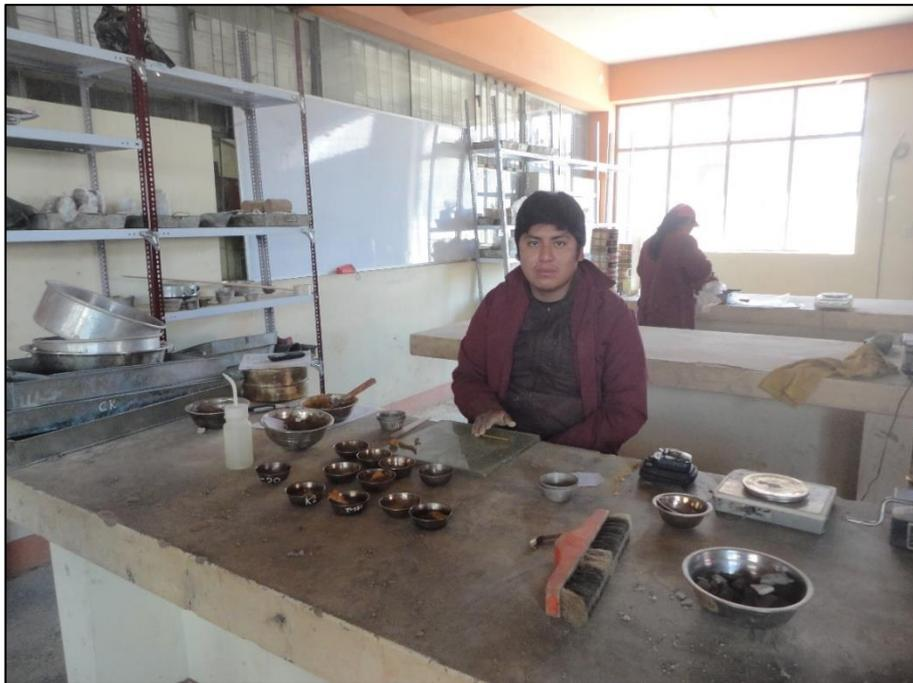
**Figura F.34.** Ensayo de límites de consistencia – Límite plástico
