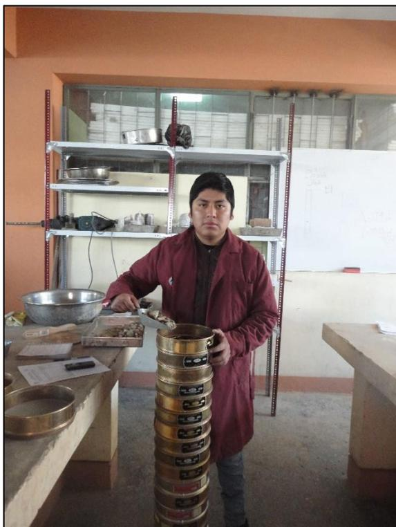
**Figura F.31.** Tamizado de la muestra
