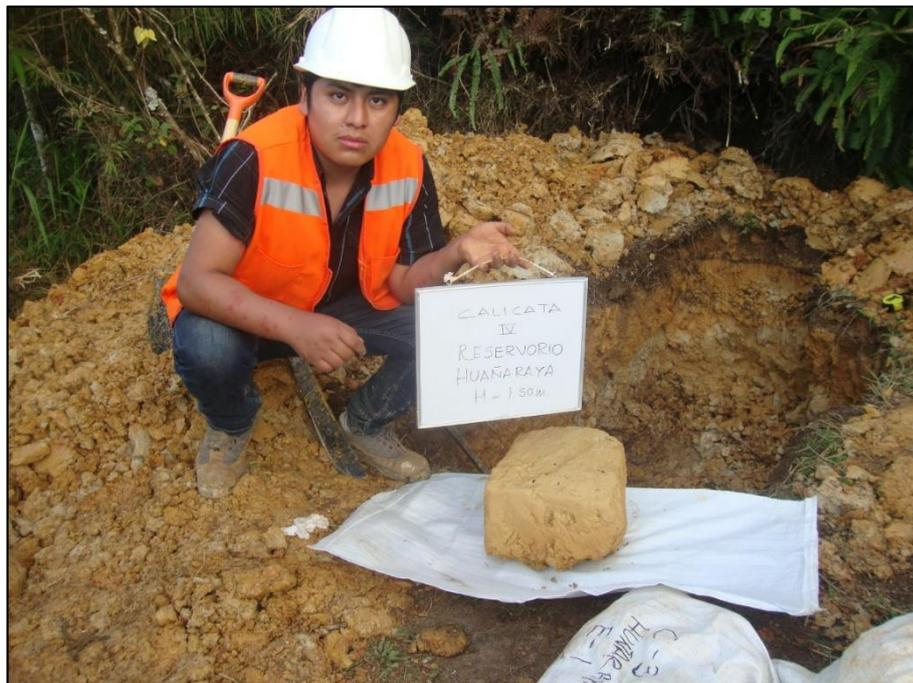
**Figura F.26.** Muestra inalterada – Reservorio Comunidad Huañaraya
