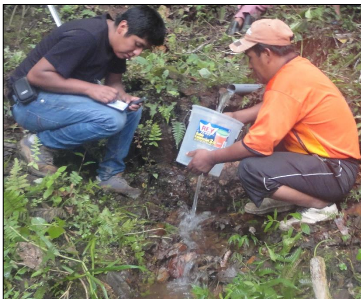
Figura 3.19. Aforo de manantial tipo ladera
