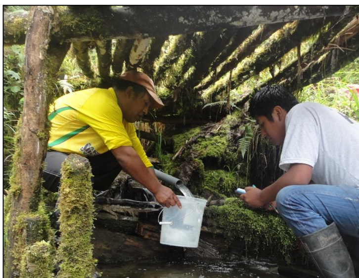
Figura 3.20. Aforo de manantial utilizando el método volumétrico
