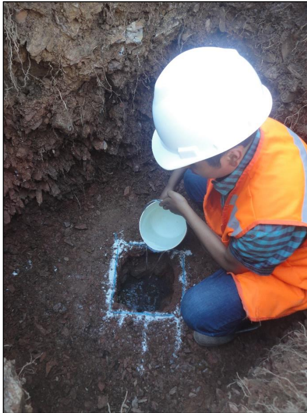
Figura 5.18. Procedimiento para el cálculo del tiempo de infiltración
