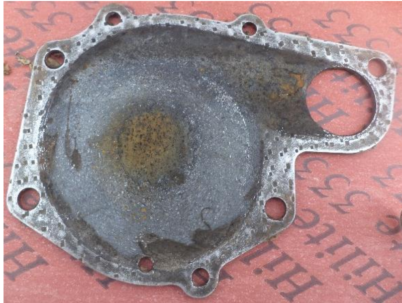
Foto N° 03: Corrosión en el componente de la bomba de agua al utilizar agua natural
