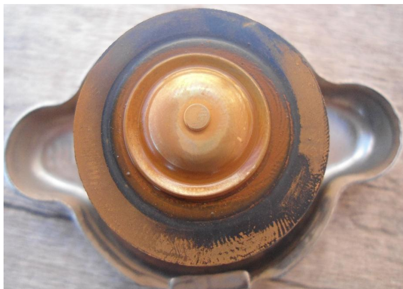
Foto N° 04: Corrosión en la tapa de radiador al utilizar agua natural
