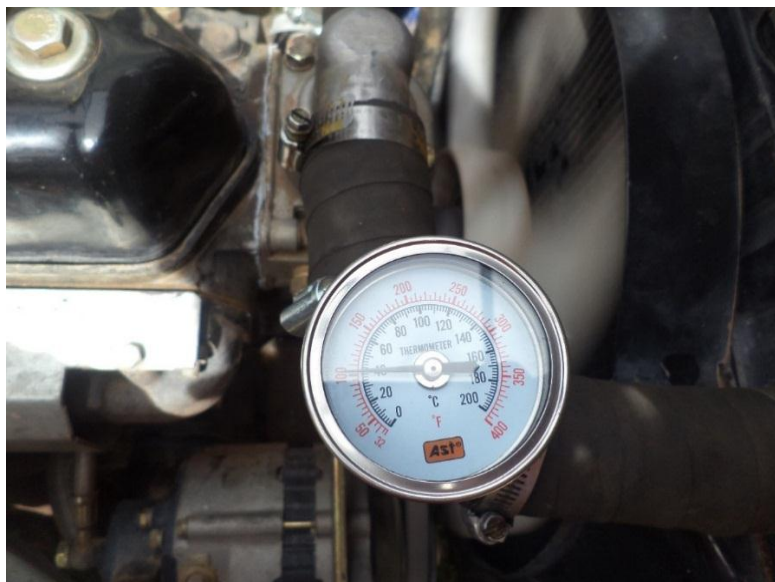
Foto N° 02: lectura del termómetro a la entrada del radiador Motor en proceso de calentamiento. Utilizando agua Como refrigerante Elaboración: propia.
