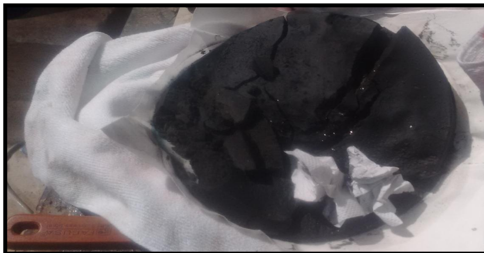
Imagen 7. Pre concentrado de oro (secado)
