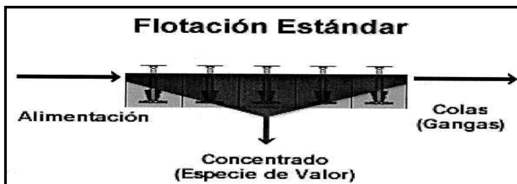
Figura 14. Flujos de alimentación de flotación de sulfuros
