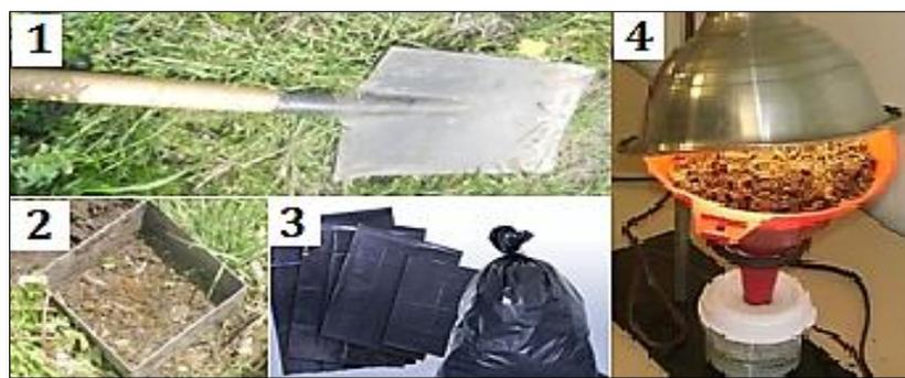
**Figura 04: Materiales Para Toma de muestra: 1) Pala, 2) Cubo de metal, 3) Bolsas de polietileno, 4) Embudo de Berlesse Tullgren**
