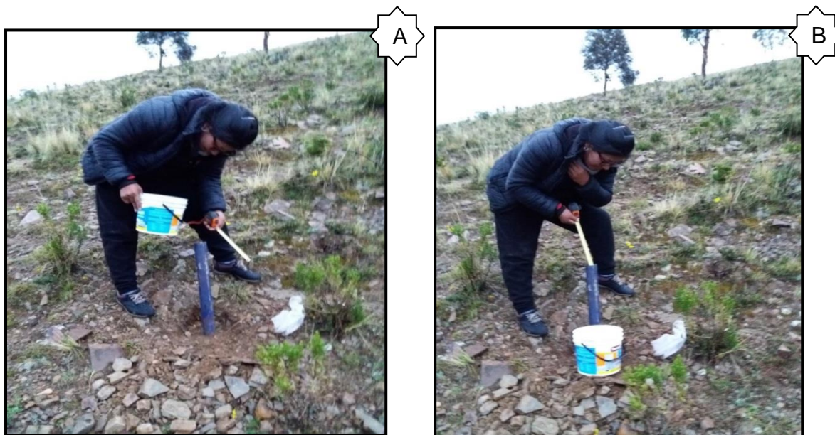
Figura 6: A) Inyectando el agua a la tubería B) se realiza mediciones de la variación del nivel de agua, según tiempos programados para la prueba
