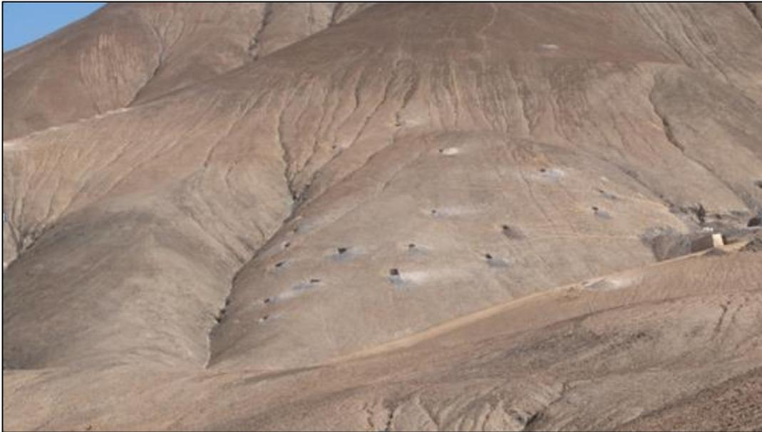
**Fig. 7: Malla de muestreo geoquímico de 0.45 x 0.70 kilómetros en un sistema de mantos de cobre en la zona de Rica.**
