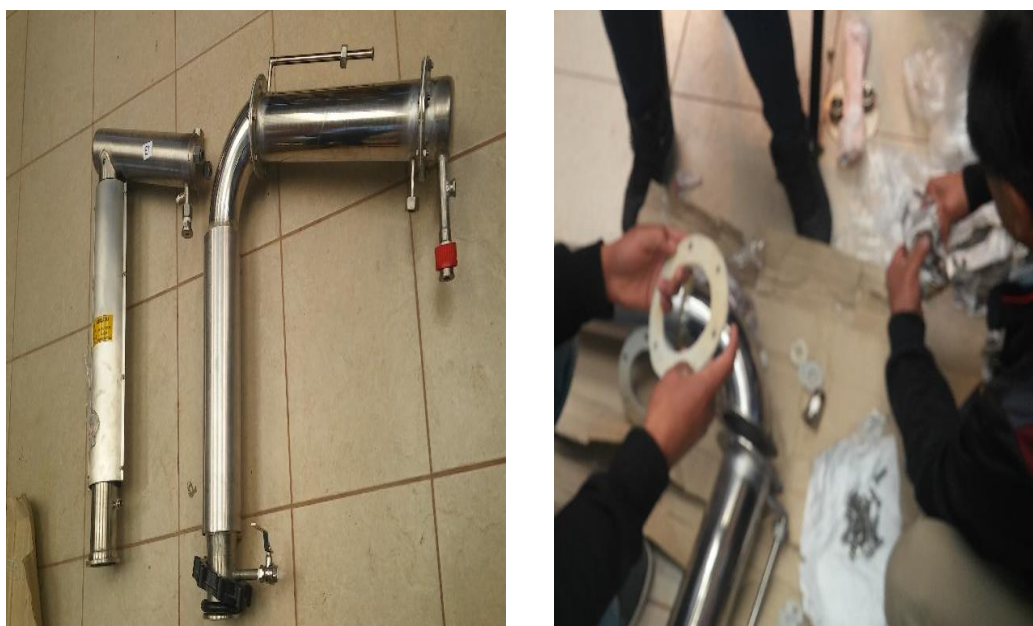
Fotografía 2: Instalación del condensador construido reemplazando al condensador de LOPU
