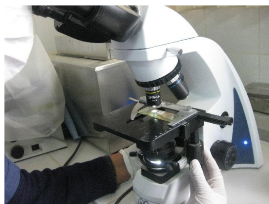
Figura 23. Enfocar la cámara de Mac Master en el microscopio a 10x, Centro de Salud Taraco.
