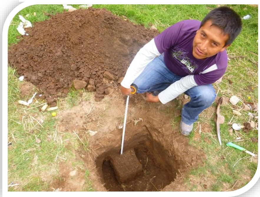
Figura 45: Tomando Muestra para saber el tipo de suelo
