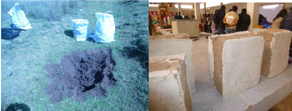
Figura 57: Extracción del suelo, y capeo del adobe
