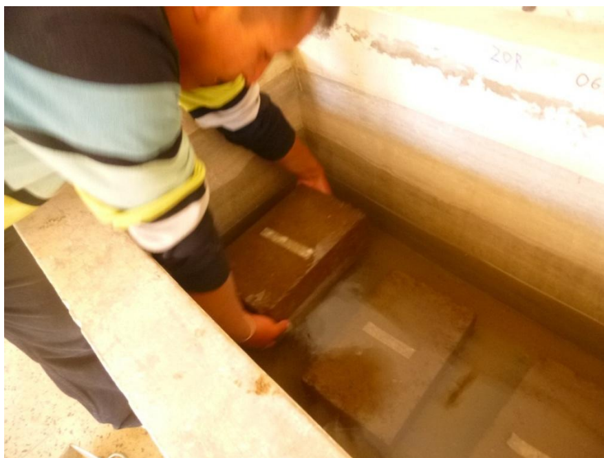
Figura 78: Ensayo de Succión en laboratorio
