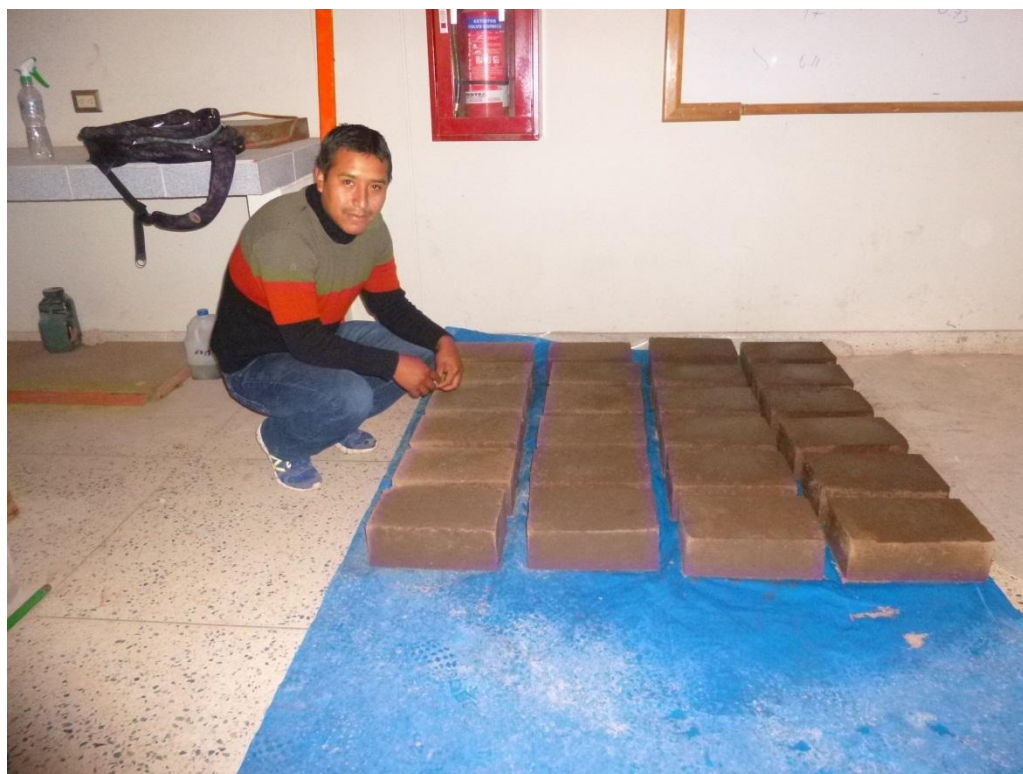
Figura 80: Secado y curado del adobe mejorado
