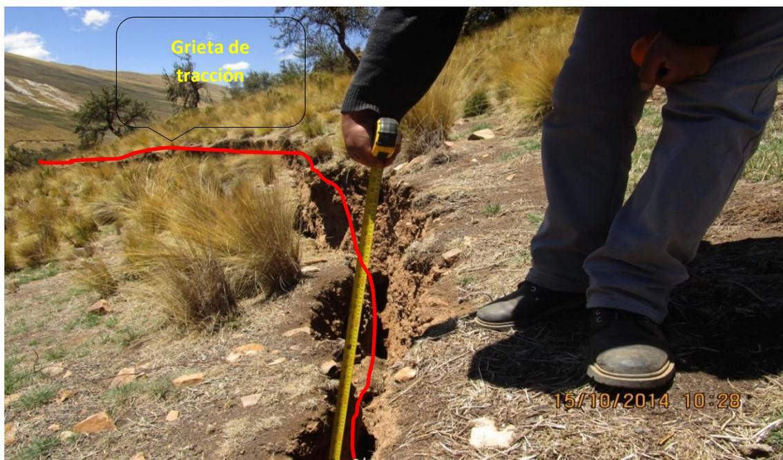
**FOTO N° 03:** Tramo Km. 11+400 – 11+600, se observa el talud fallado con superficie de ruptura circular y grieta de tracción. Medida de profundidad de la fractura.
