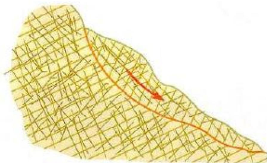
**Figura 24:** Esquema de rotura curva en macizos rocosos intensamente fracturados.
