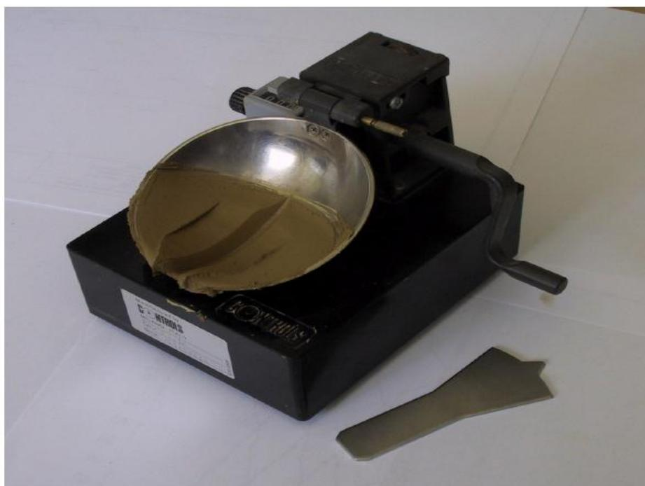
**Figura 13:** Cuchara de casagrande para determinar Límite Líquido
