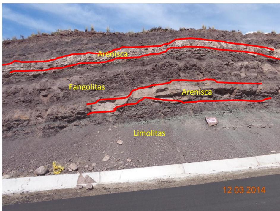
**Figura 19:** En la fotografía se aprecia intercalación de arenisca, limolita y fangolita con matriz arenosa de origen fluvial, coloración rojo brunáceo debido a la presencia ferruginosa.
