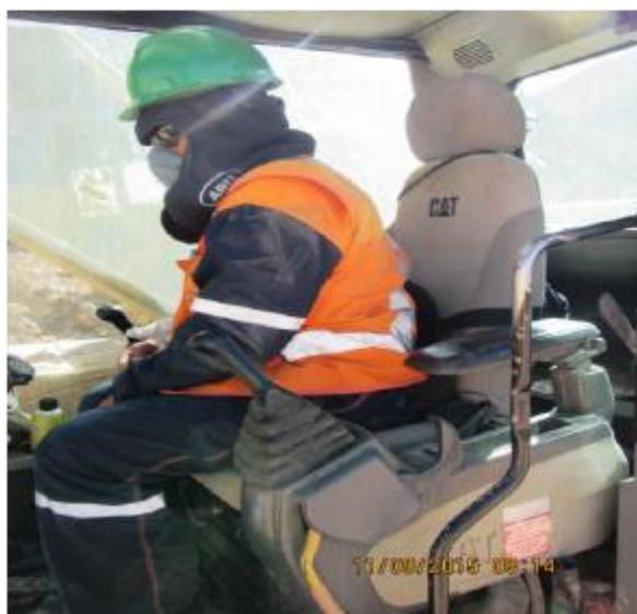
Figura N° 43. En la foto se observa el desarrollo del monitoreo vibración al operador de excavadora, Fuente: Departamento Seguridad Ajani
