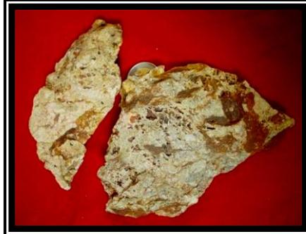
Figura N° 12. En la foto se observa una muestra de Volcanoclásticos Lamparasi, secuencia que hospeda la mineralización en zona valle, Fuente: Departamento Geología UM Aruntani
