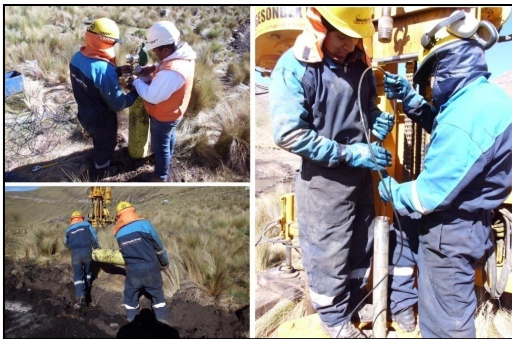
Figura N° 48. : Ensayos de permeabilidad tipo Lugeon (fuente: propia).
