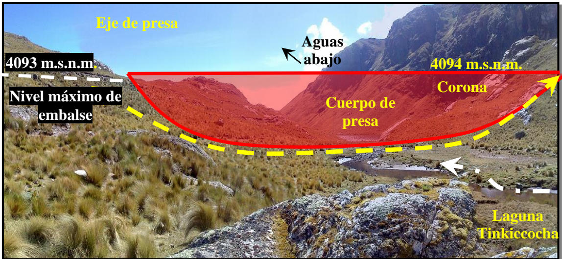
Figura N° 49. : Esquema de la presa proyectada Tinkiccocha (fuente: propia).
