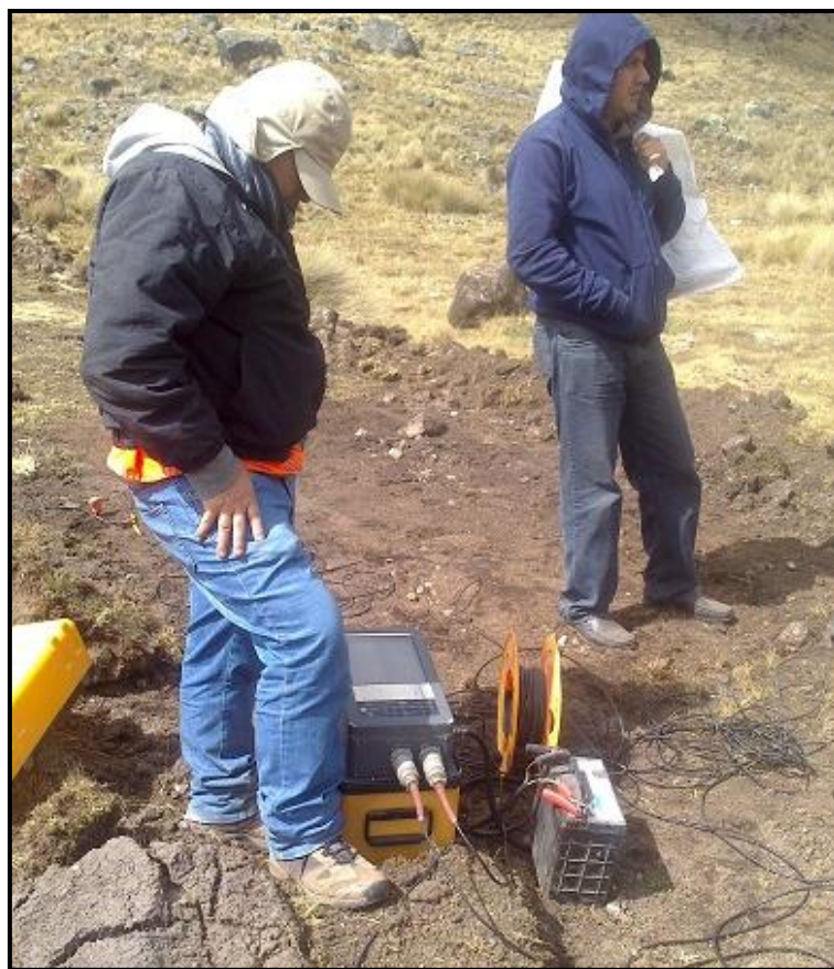
Figura N° 37. : Fotografía de la lectura del dispositivo Switch para la obtención de las dromocrónicas (fuente: propia).
