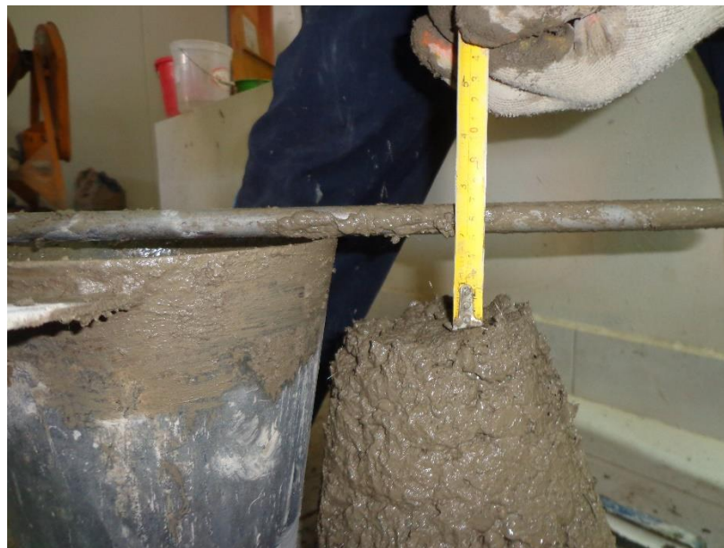
Figura 3. 3 Ensayo de revenimiento o asentamiento en el cono de Abrams
