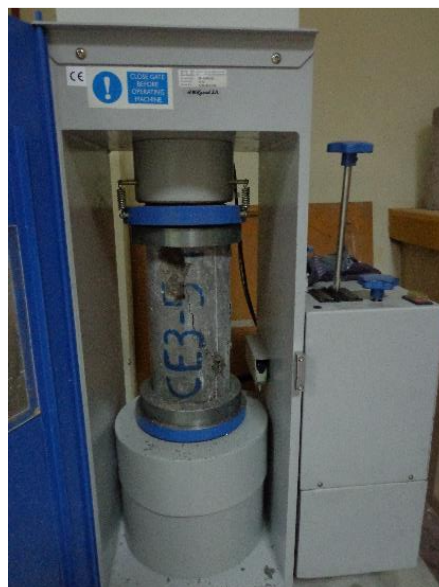
Figura 3. 4 Ensayo de compresión del concreto
